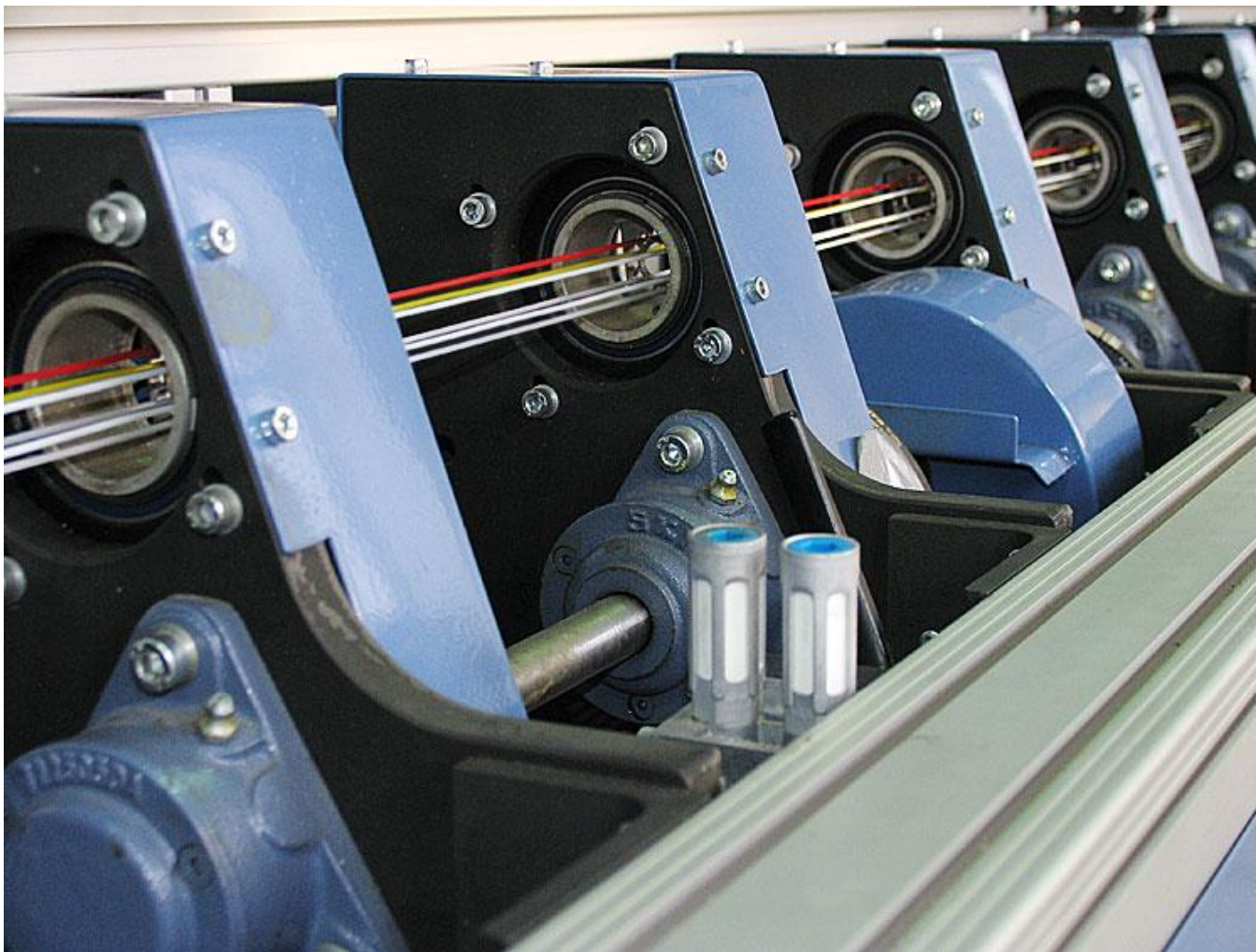
ОВ в оптических модулях
