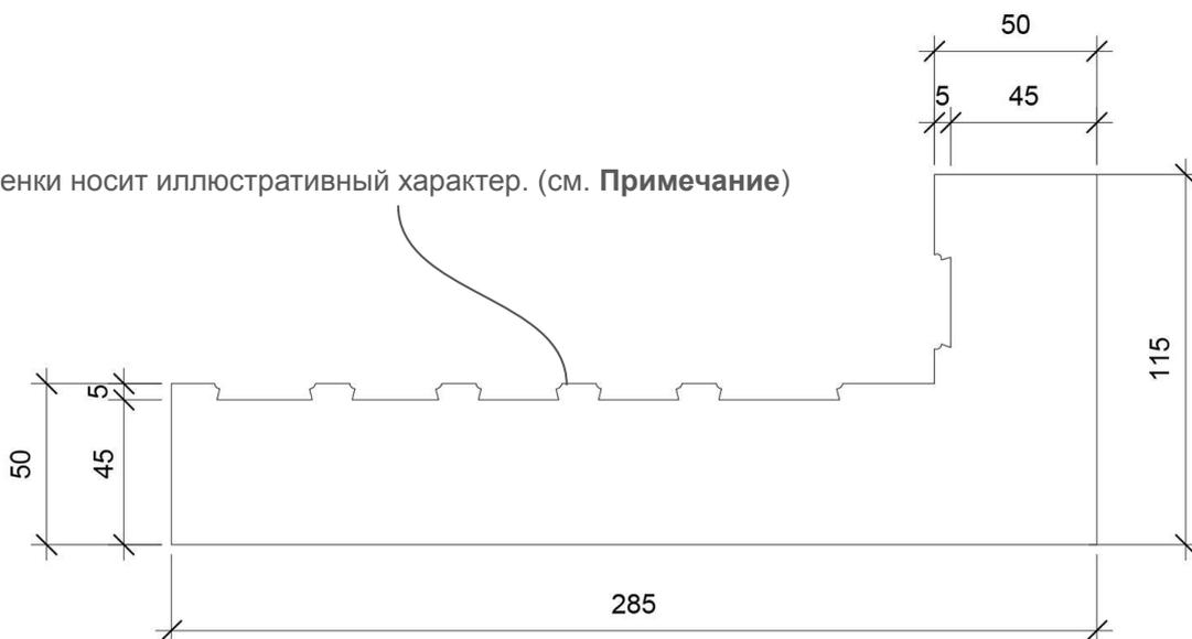
**Примечание. Требование к гребенке.** Гребенка должна обеспечить максимальное сцепление с бетоном (принцип ласточкиного хвоста - форма может быть изменена по согласованию) и возможность ломания кирпича на части в соответствии с чертежом на стр.14.
