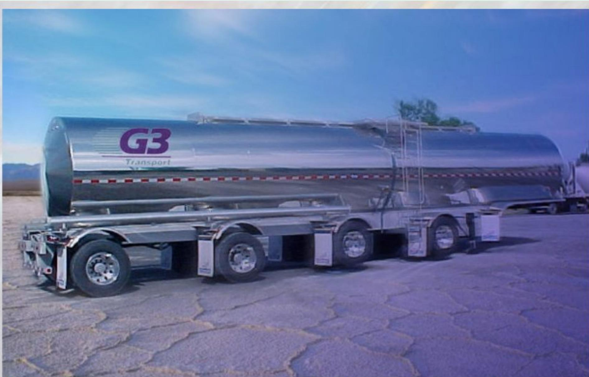
Цистерна изготовлена из коррозионно-стойкой (нержавеющей стали).
