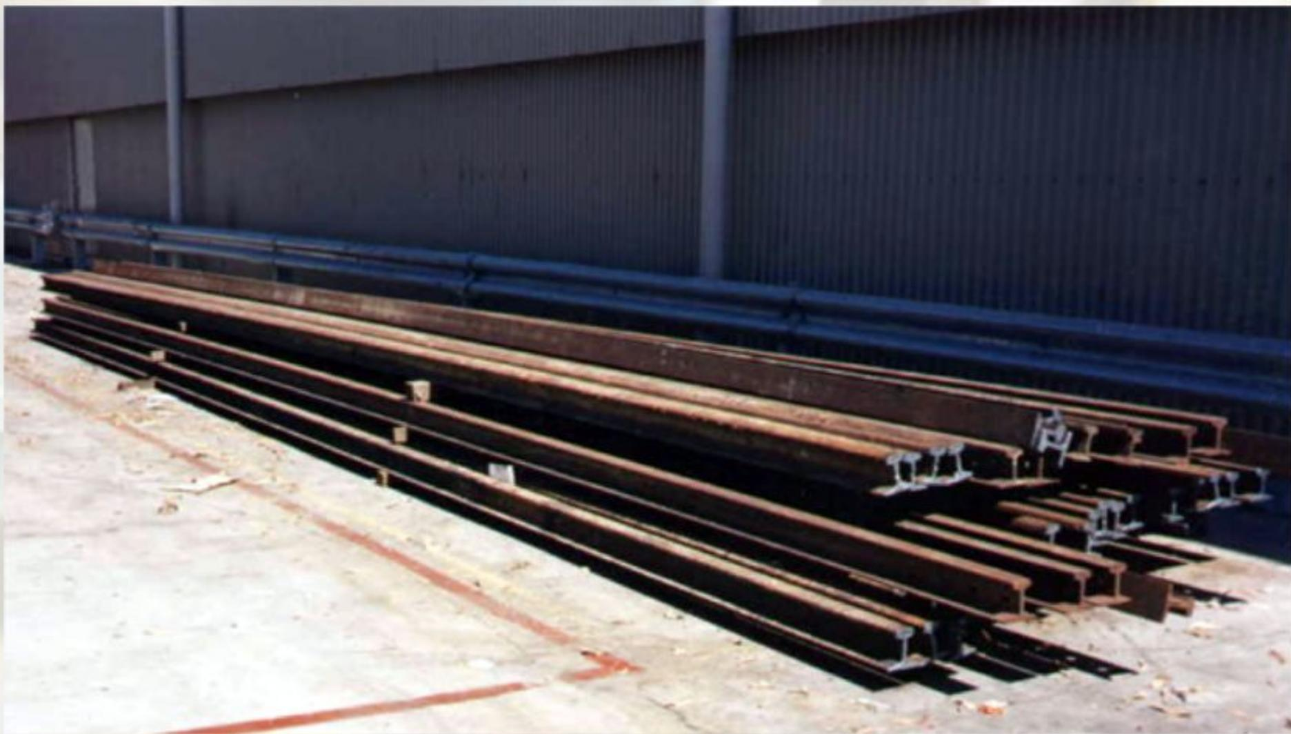
**Нелегированная сталь со средним содержанием углерода** пригодна для таких изделий, от которых требуются прочность и сопротивление износу, например для рельсов.
