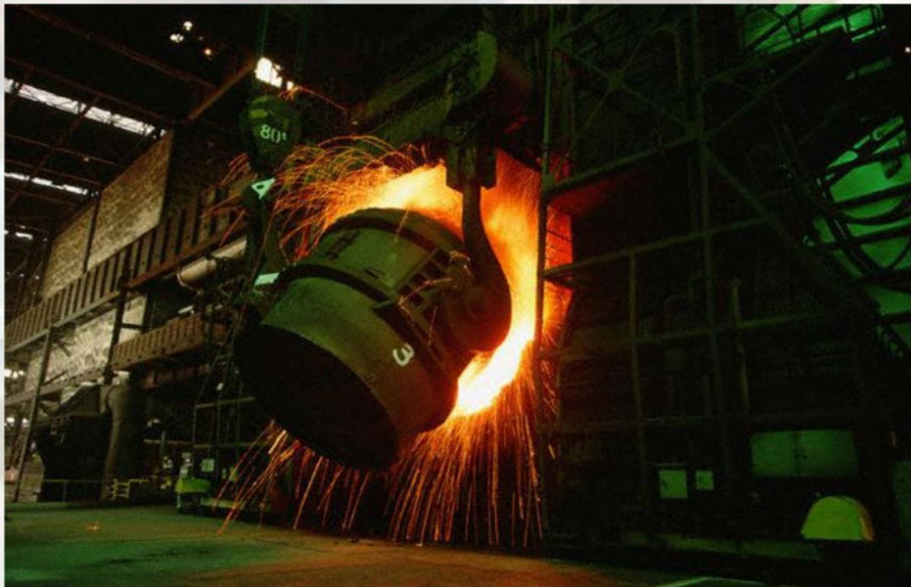
**Сталь** – это, прежде всего, сплав железа с углеродом. В такой сплав могут входить и другие элементы, но углерод – неперенный компонент стали. Содержание углерода в стали может достигать примерно 2%.
