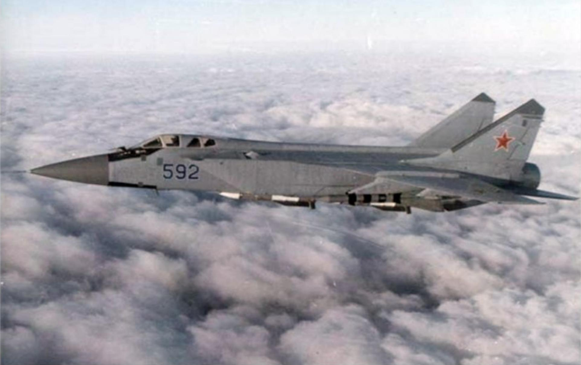
Планер самолета **МиГ-31** изготовлен на 50% из **нержавеющей стали**. У его предшественника МиГ-25 в стальных конструкциях было 80%.
