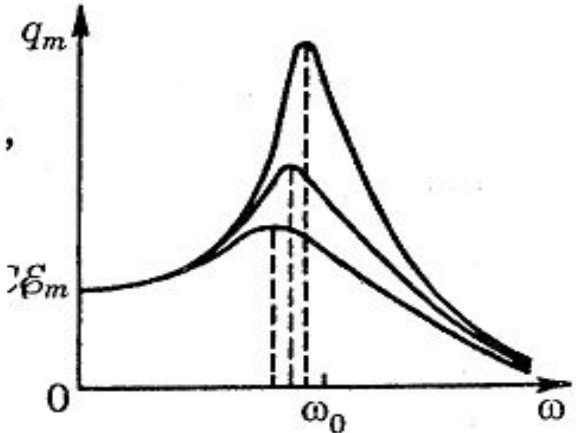
*Резонансные частоты и кривые при резонансе напряжения
