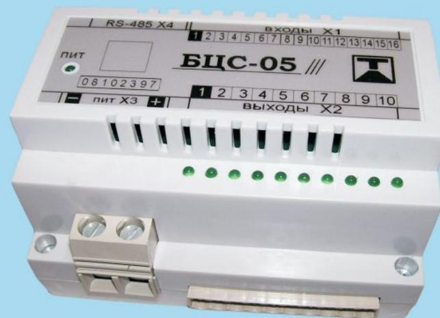
Блок цифровых сигналов предназначен для приема цифровых сигналов с датчиков, обработки этих сигналов и передачи по интерфейсу RS-485 управляющему контроллеру, а также выдачи управляющих сигналов на исполнительные устройства в соответствии с командами от управляющего контроллера.
