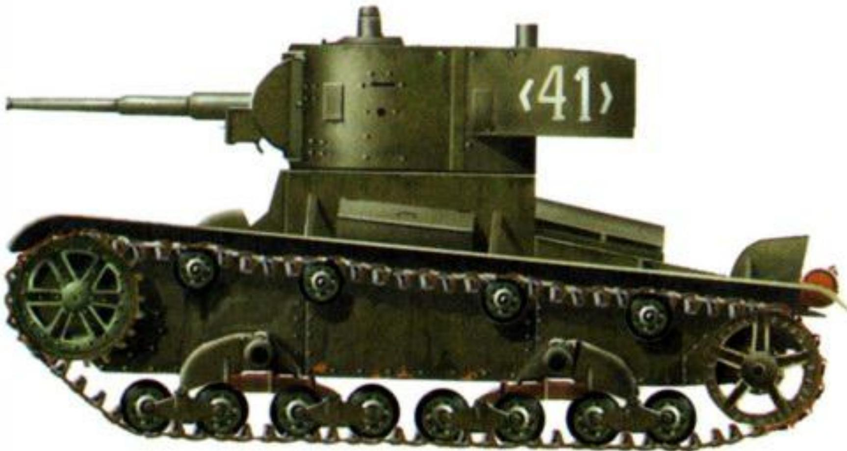
T-26 поздних серии выпуска приобрели коническую башню, немного более мощное бронирование и двигатель незначительно повышенной мощности. Такие машины воевали и в начальный период Великой Отечественной, но почти все были вскоре уничтожены в боях. До середины войны прослужили лишь созданные на их базе инженерные машины и командирские танки с более мощными радиостанциями.
