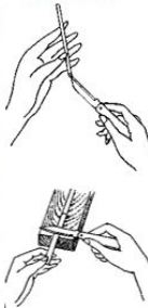
Мал. 1. Падрэжкі сцібла саломкі да работы: а - расшчэпленне; б - расшчэпленне
