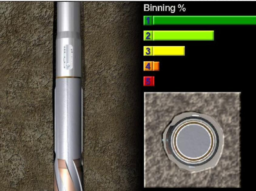
Разбивка на бины это собственный метод компании для сбора и записи данных плотности в соответствии с отходом от стенки скважины.
