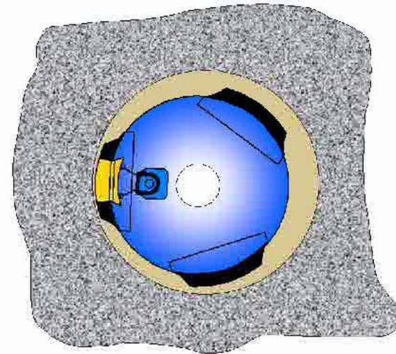
INTEQ разработал уникальный метод для уменьшения влияния скважины на каротаж плотности при работе с ЛитоТраком
