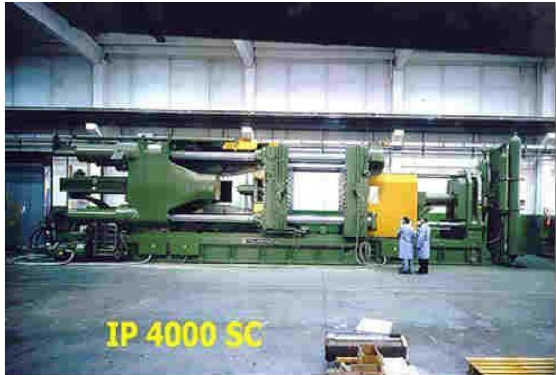
Tlakový lici stroj ItalPresse s uzavírací silou 4400 tmm
