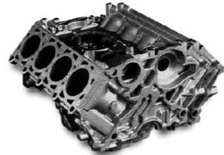
Blok motoru 12L pro nákladní vozy a lokomotivy [DAWSON, S. Practical Iron. Sinter Cast [online]]
