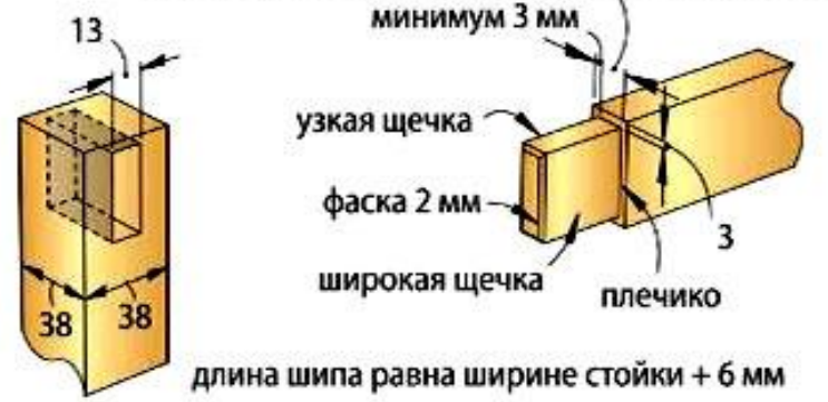
Соединение деталей разной толщины
