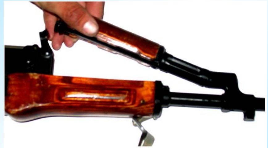
Отделить газовую трубку со ствольной накладкой
