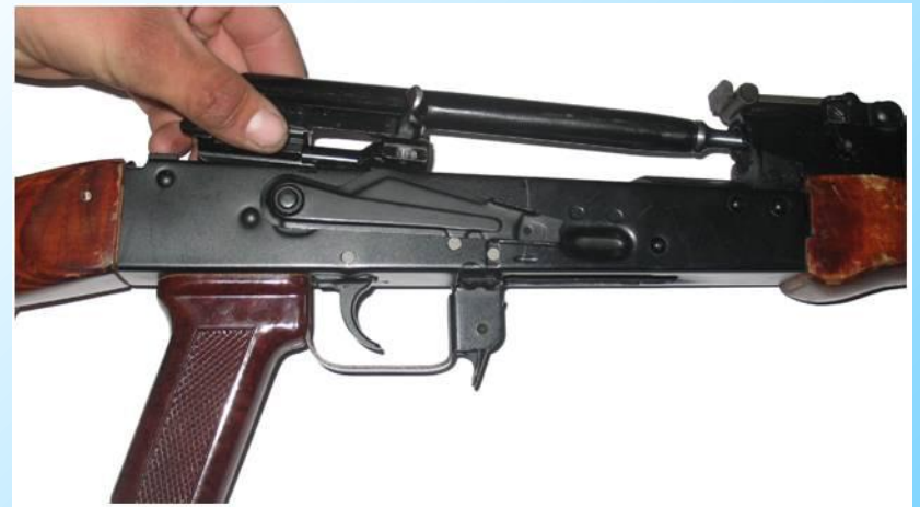
Отделить затворную раму с затвором
