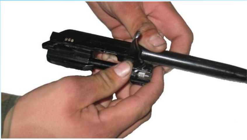
Отделить затвор от затворной рамы
