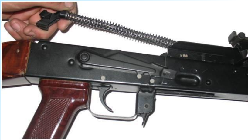
Отделить возвратный механизм
