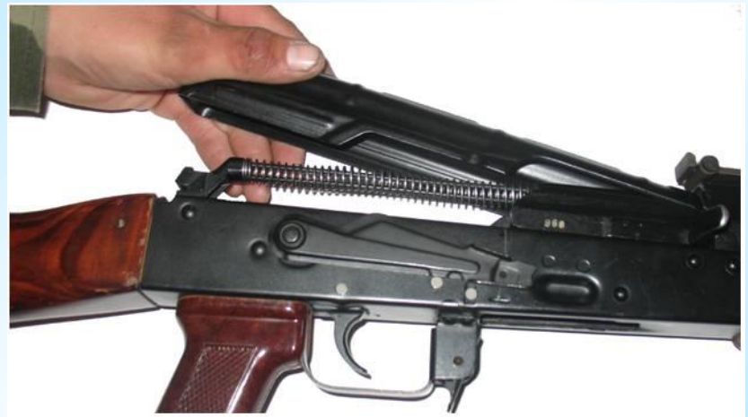
Отделить крышку ствольной коробки
