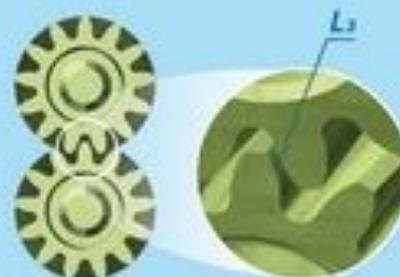
Допускается стук роторов при повороте ведущего ротора в прямом и обратном направлениях
