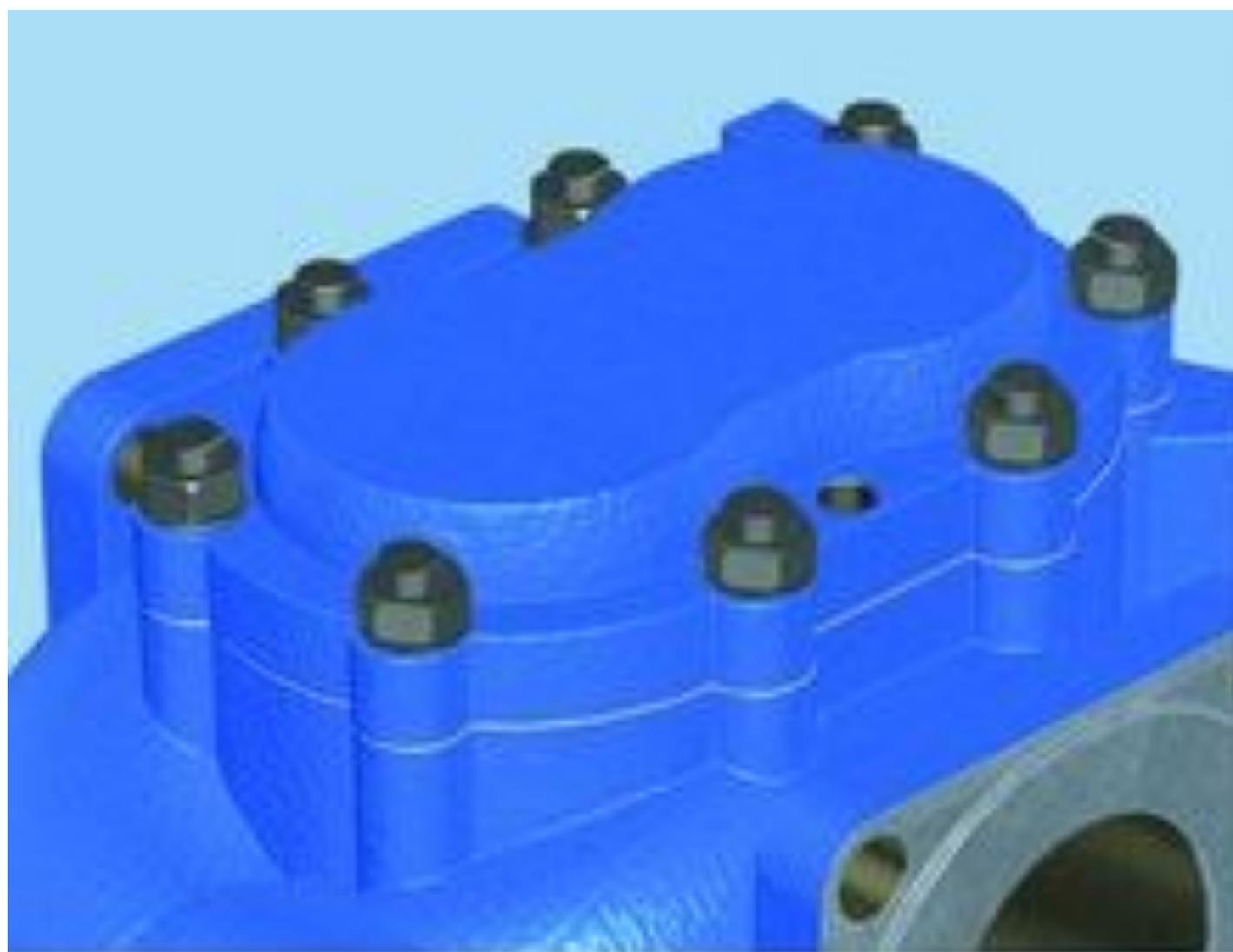
**Равномерно обтянуть гайки крышки**
