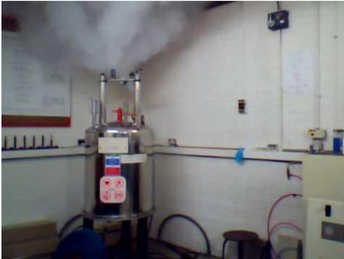
NMR Oxford Superconducting magnet quench (Кипение жидкого гелия)
