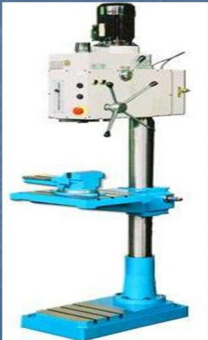
предназначен для сверления, рассверливания, зенкерования, зенкования, развертывания и нарезания резьбы в различных видах металлических и неметаллических деталей быстрорежущим и твердосплавным инструментом. Отличительные особенности:
