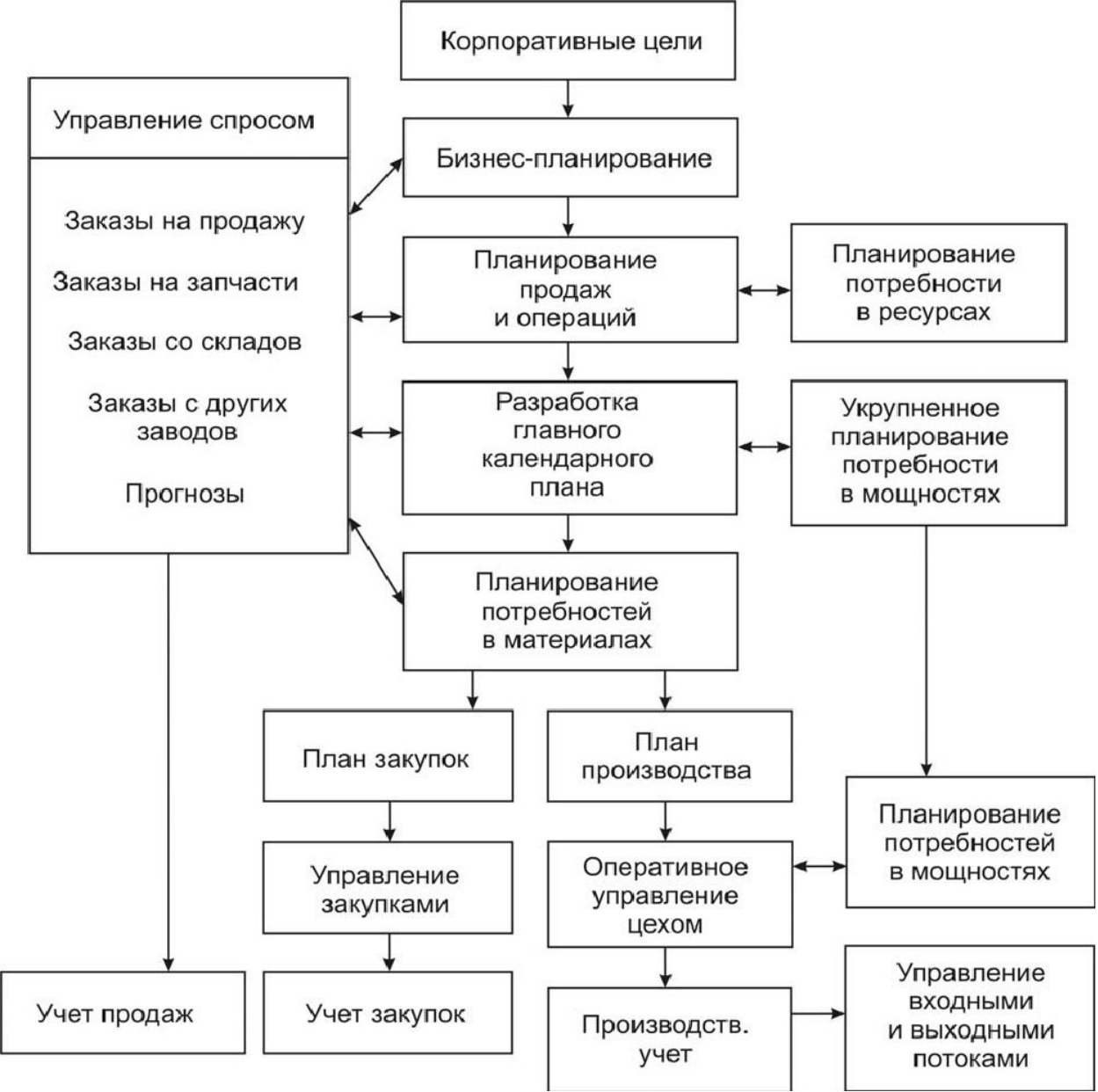
Рис. 1.2. Укрупненная структурная схема MRP II
