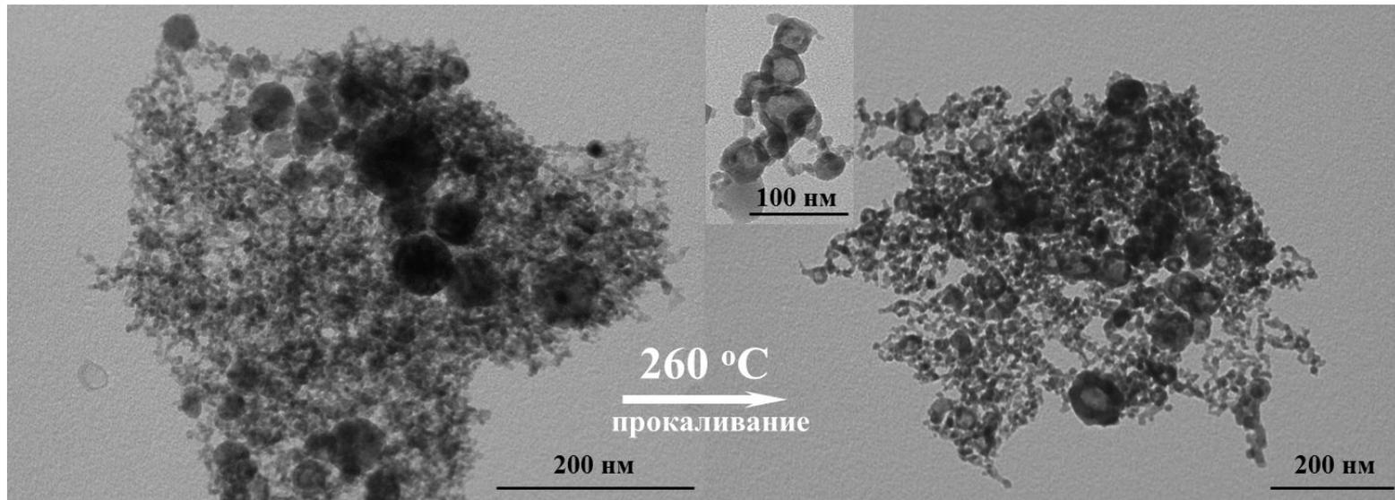
*ПЭМ изображения НЧ, полученных лазерной абляцией меди в углекислом газе, исходный (слева) и прокаленный при 260 °С (справа)*
