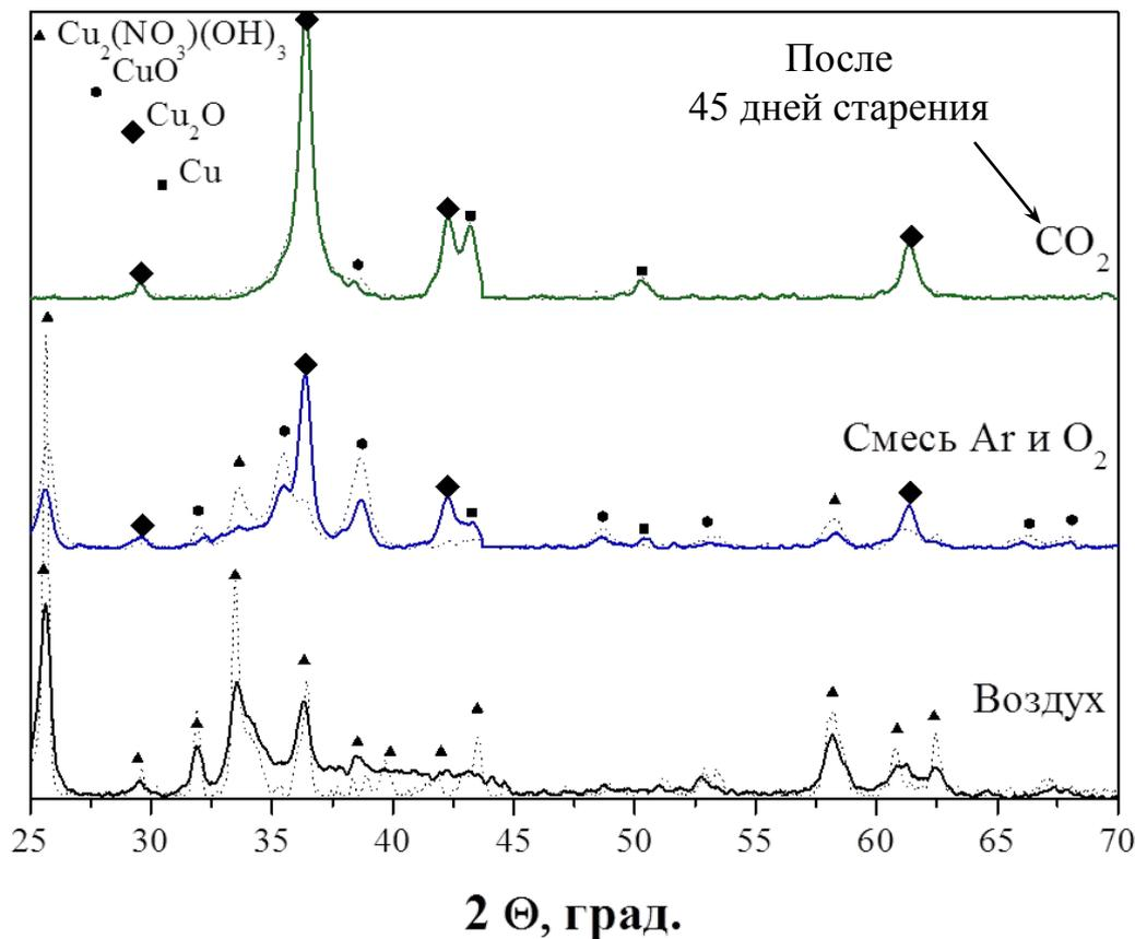
*Дифрактограммы порошков, полученных лазерной абляцией меди в различных газовых средах свежеприготовленные порошки (прямая линия), состаренные (пунктирная линия)*
