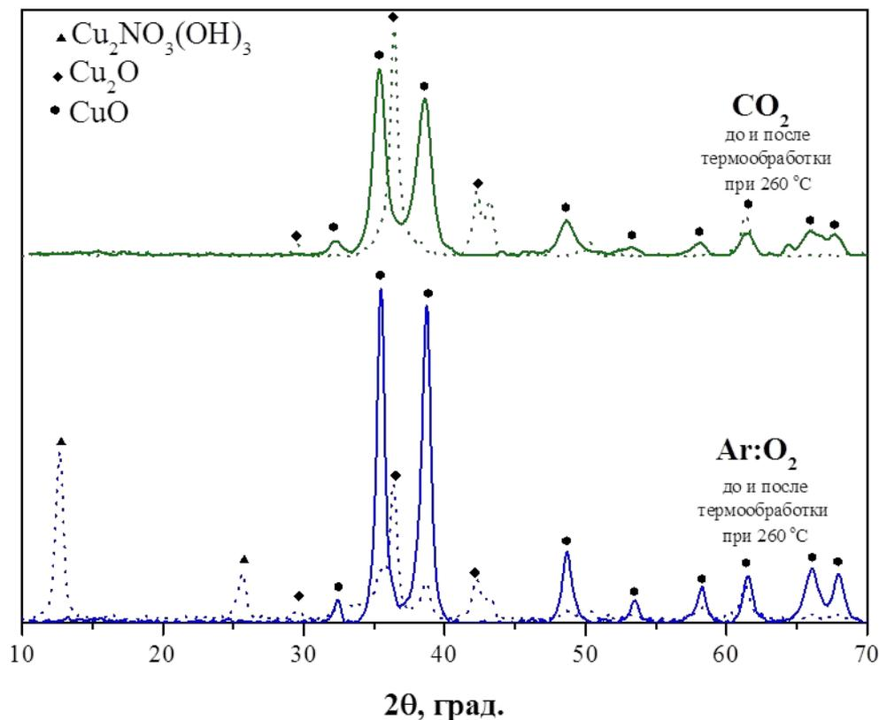
*Дифрактограммы порошков, полученных лазерной абляцией меди в различных газовых средах отожженных при  $260^\circ\text{C}$  (прямая линия), свежеприготовленные порошки (пунктирная линия)*
