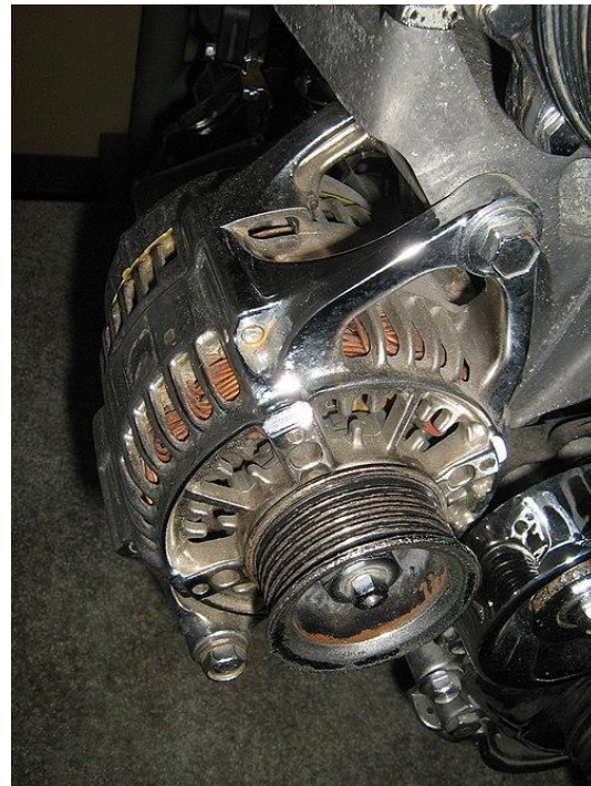
Автомобильный генератор переменного тока. Приводной ремень снят.
