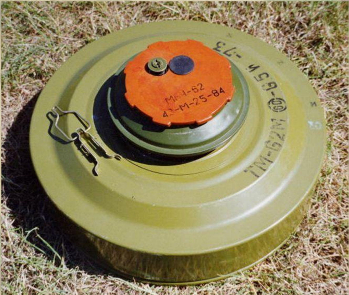
Противотанковая мина ТМ-62М с нажимным взрывателем
