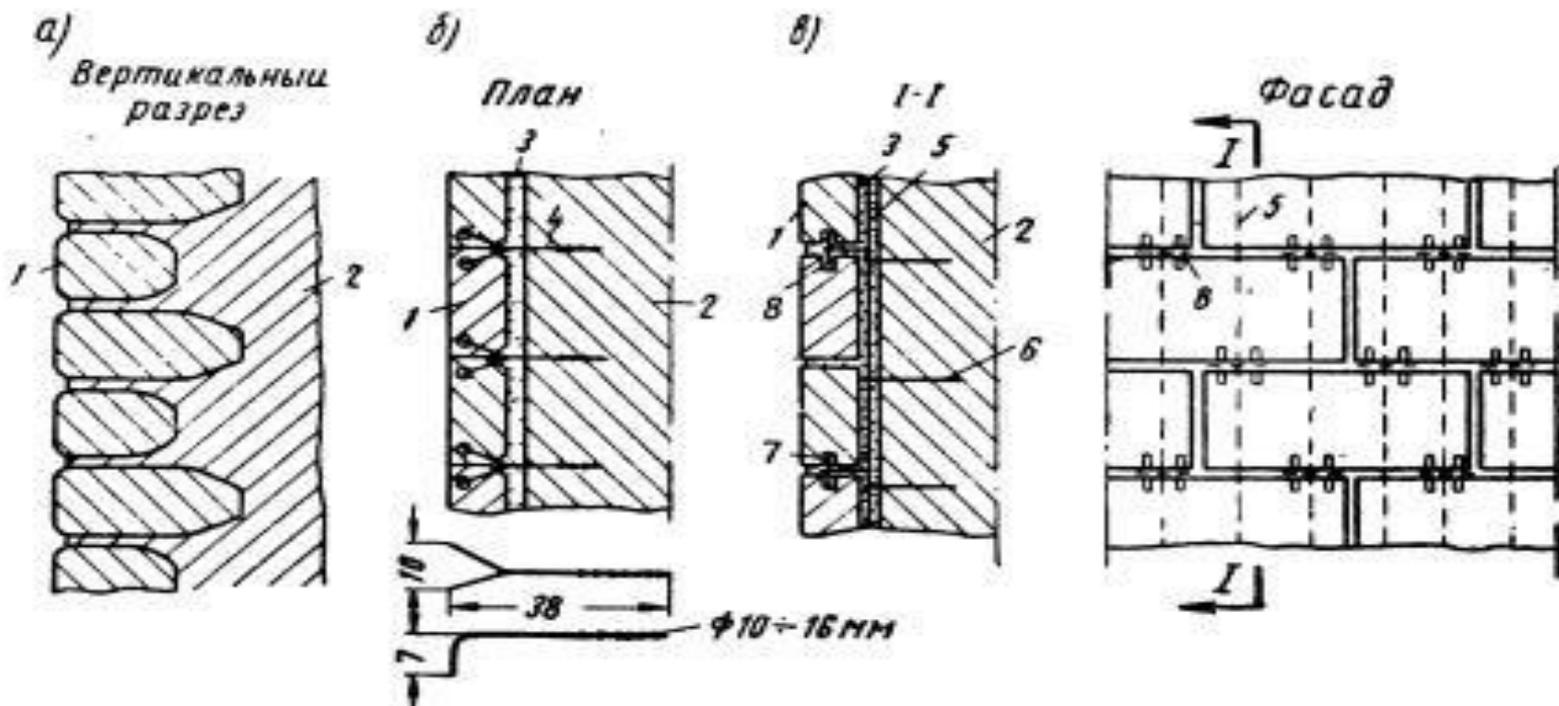
Рис. 51. Типы облицовки монолитных опор:
