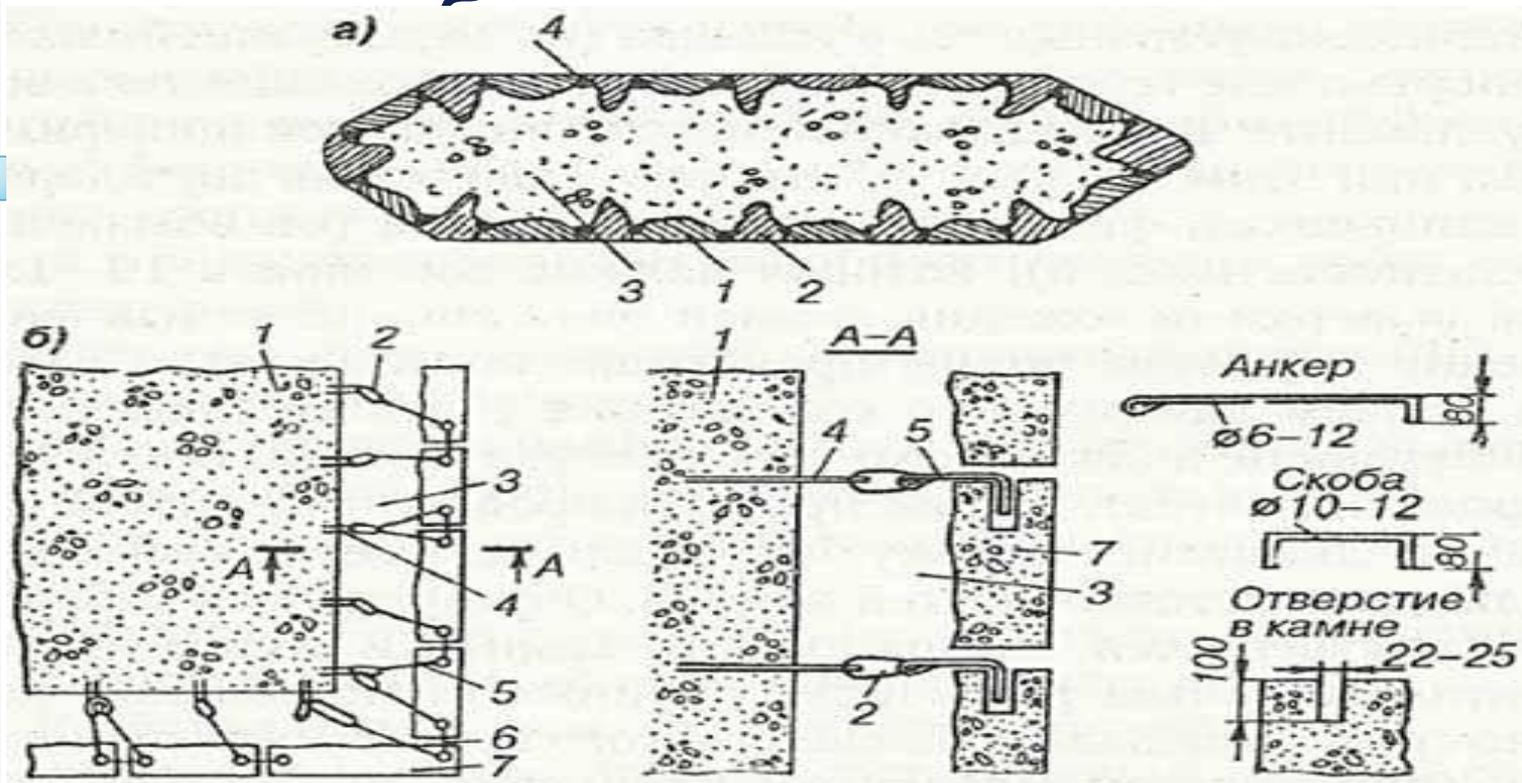
Облицовка тела опоры: а – массивная; б – навесная; 1 – облицовочный камень ложковый; 2 – то же, тычковый; 3 – бетон ядра тела опоры; 4 – «колодец»; 5 – облицовочная плита; 6 – петля,
