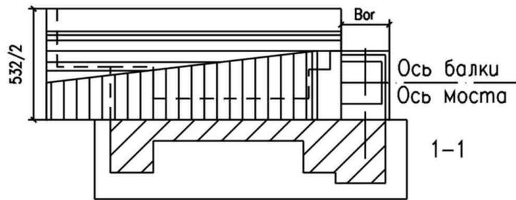
**Идея обсыпного устоя - максимально уменьшить объем бетонной кладки. С этой целью, в частности, подферменные площадки устоя стремятся приблизить к поверхности конуса на минимальное расстояние, при котором, однако, еще сохраняется гарантия того, что опорные части пролетного строения не будут засоряться. Необсыпные устои значительно массивнее обсыпных (особенно при высоких насыпях), но надежно удерживают насыпь. Обсыпные устои могут быть очень легкими, экономичными (особенно у автодорожных**
