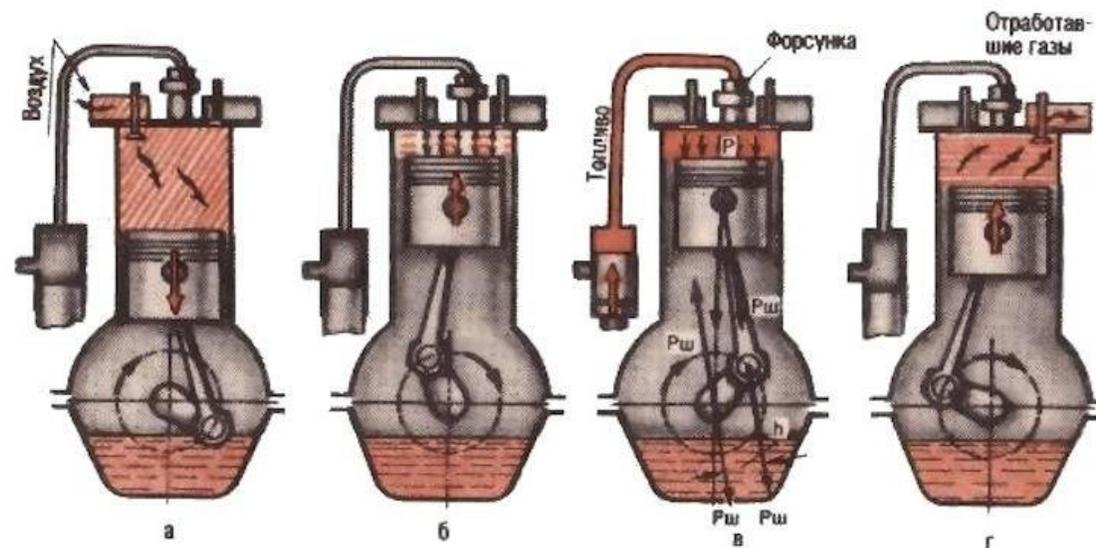
Рисунок. 1. Схема рабочего процесса четырехтактного дизеля:
