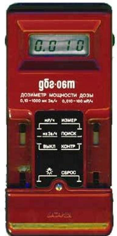
Дозиметр применяется для оперативного группового контроля мощности эквивалентной дозы окружающей среды или мощности экспозиционной дозы работниками служб радиационной безопасности, дефектоскопических лабораторий, санитарно-эпидемиологических станций и т.д.
