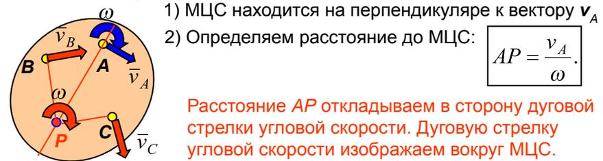
3) Соединяем точки  $B$  и  $C$  с МЦС и определяем скорости этих точек:
