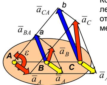
Концы векторов ускорений точек  $a_{BA}$  и  $a_{CA}$  лежат на одной прямой  $abc$  и делят ее на отрезки пропорциональные расстояниям между точками:
