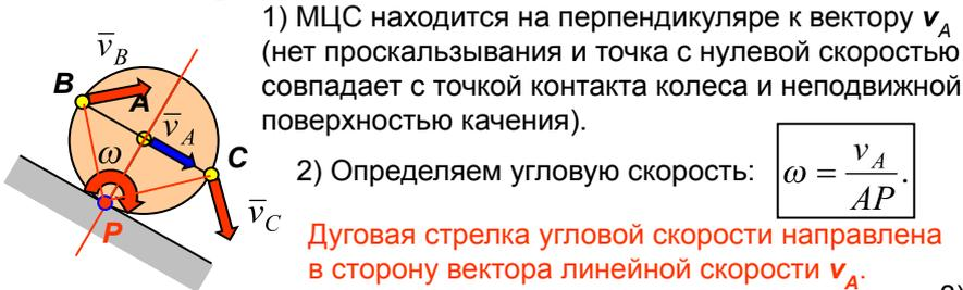
3) Соединяем точки  $B$  и  $C$  с МЦС и определяем скорости этих точек:
