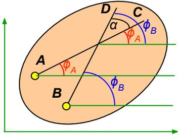
Углы наклона отрезков к горизонтальной оси различны и связаны между собой соотношением:  $\varphi_B(t) = \varphi_A(t) + \alpha$ .
