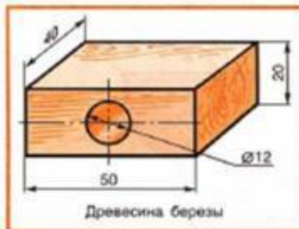
Рис. 14. Технический рисунок детали
