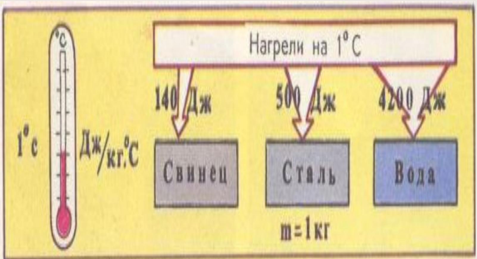
Физическая величина, численно равная количеству теплоты, которое необходимо передать телу массой 1 кг. для того, чтобы его температура изменилась на  $1^{\circ}\text{C}$ , называется удельной теплоемкостью вещества (с).
