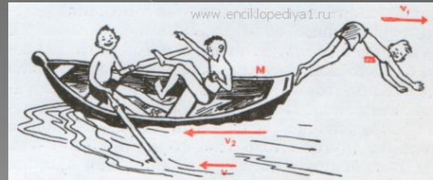
Рис. 4. По закону о сохранении движения  $(m+M)v= mv_1+Mv_2$ .
