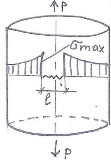
если металл пластичен, то в вершине трещины происходит ПД, трещина затупляется и дальше не идёт
