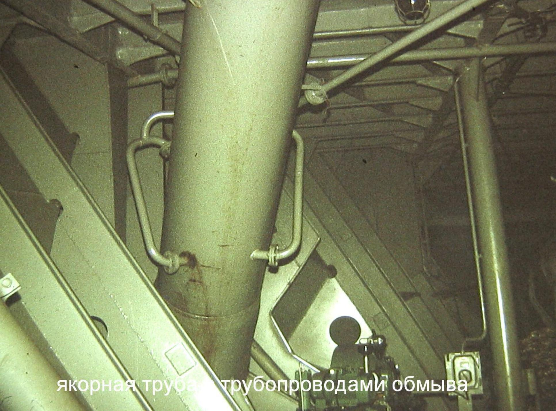
якорная труба с трубопроводами обмыва
