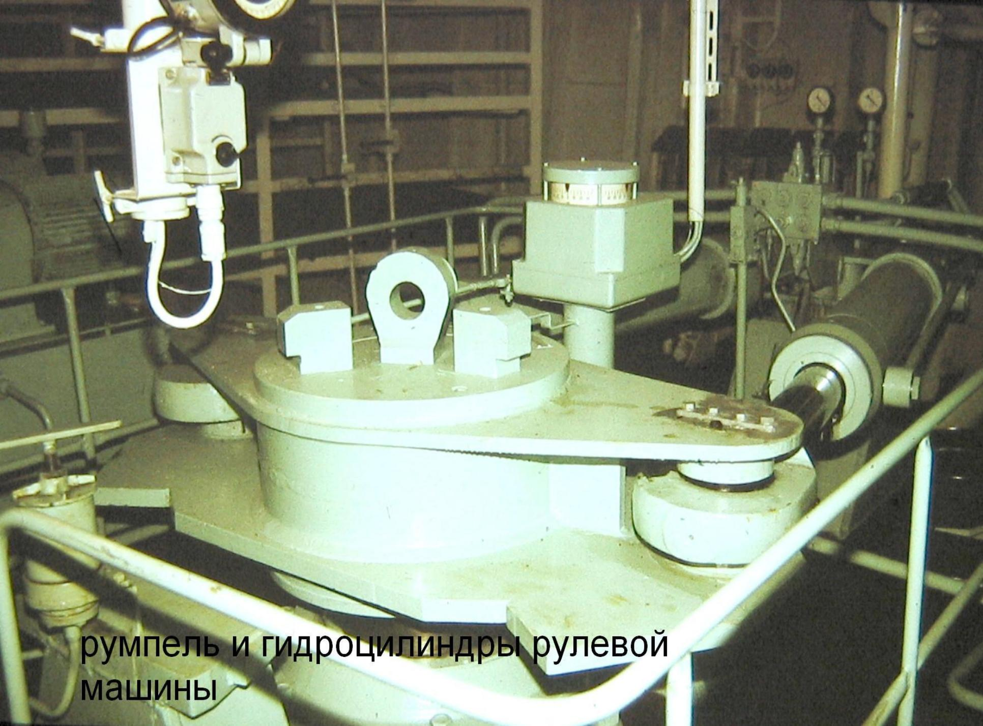
румпель и гидроцилиндры рулевой машины
