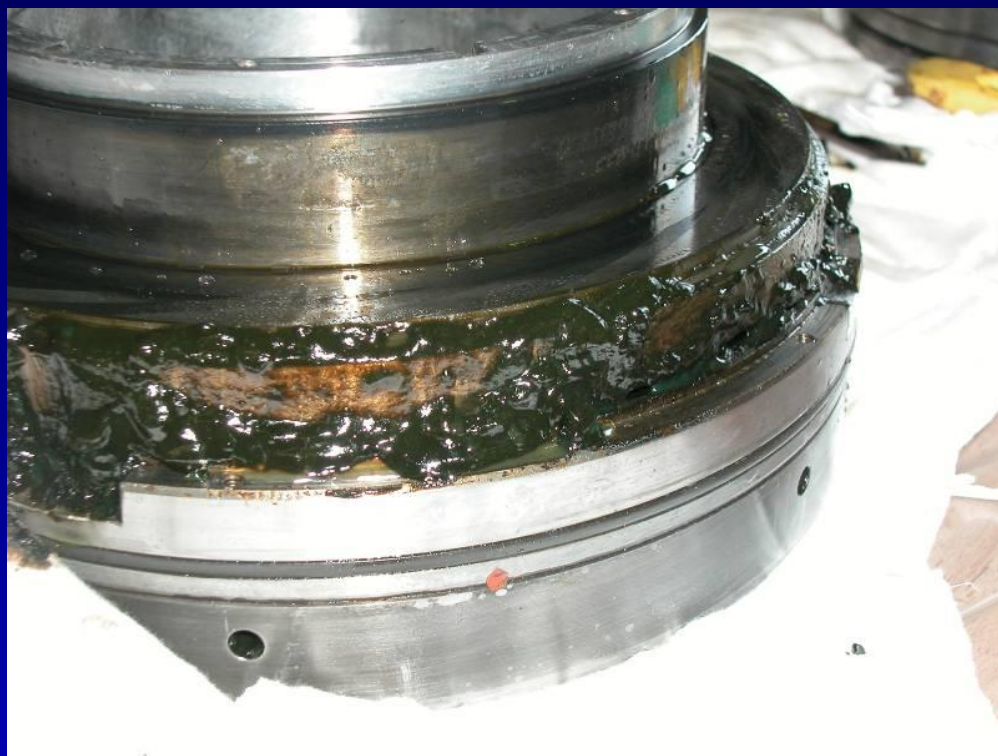
Выпадение углеводородного осадка на внутренних поверхностях уплотнения
