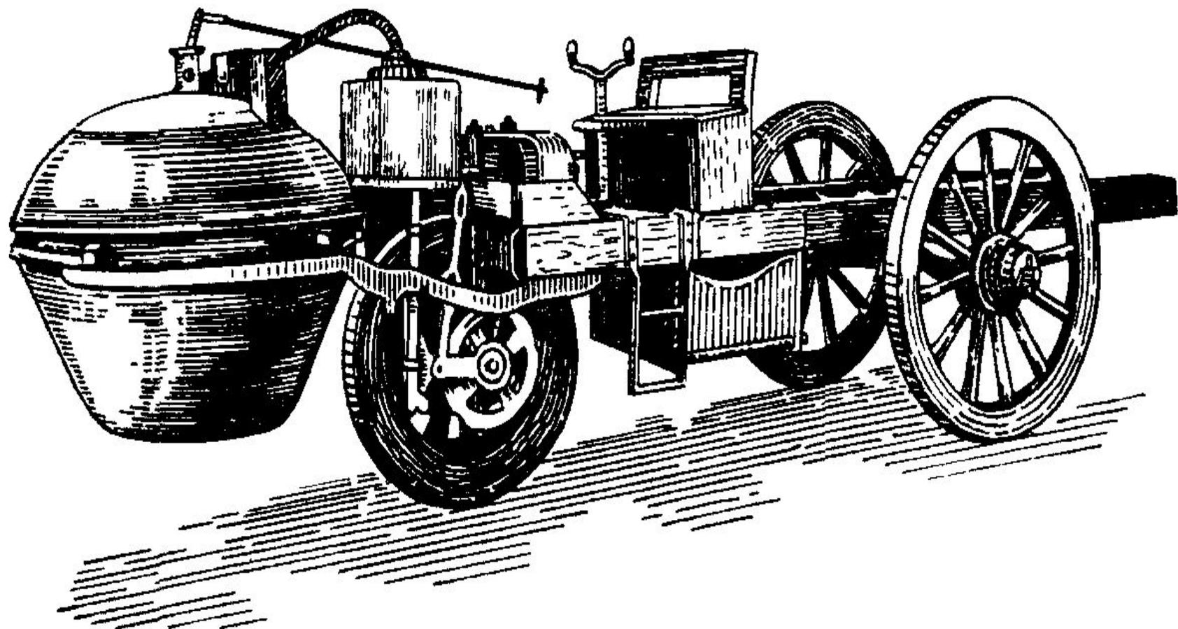
*Рис. 10. Паровая повозка Ж. Кюньо*
