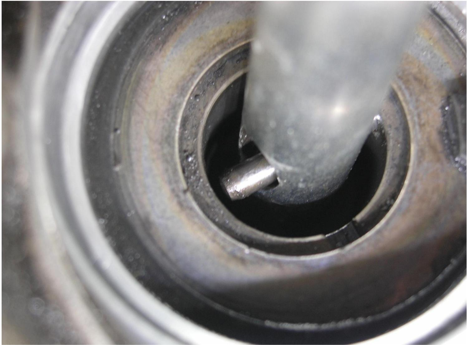
2. Легкими ударами молотка сдвигаем штифт на несколько миллиметров. Далее удаляем его обычными плоскогубцами и вынимаем шток привода сцепления.
