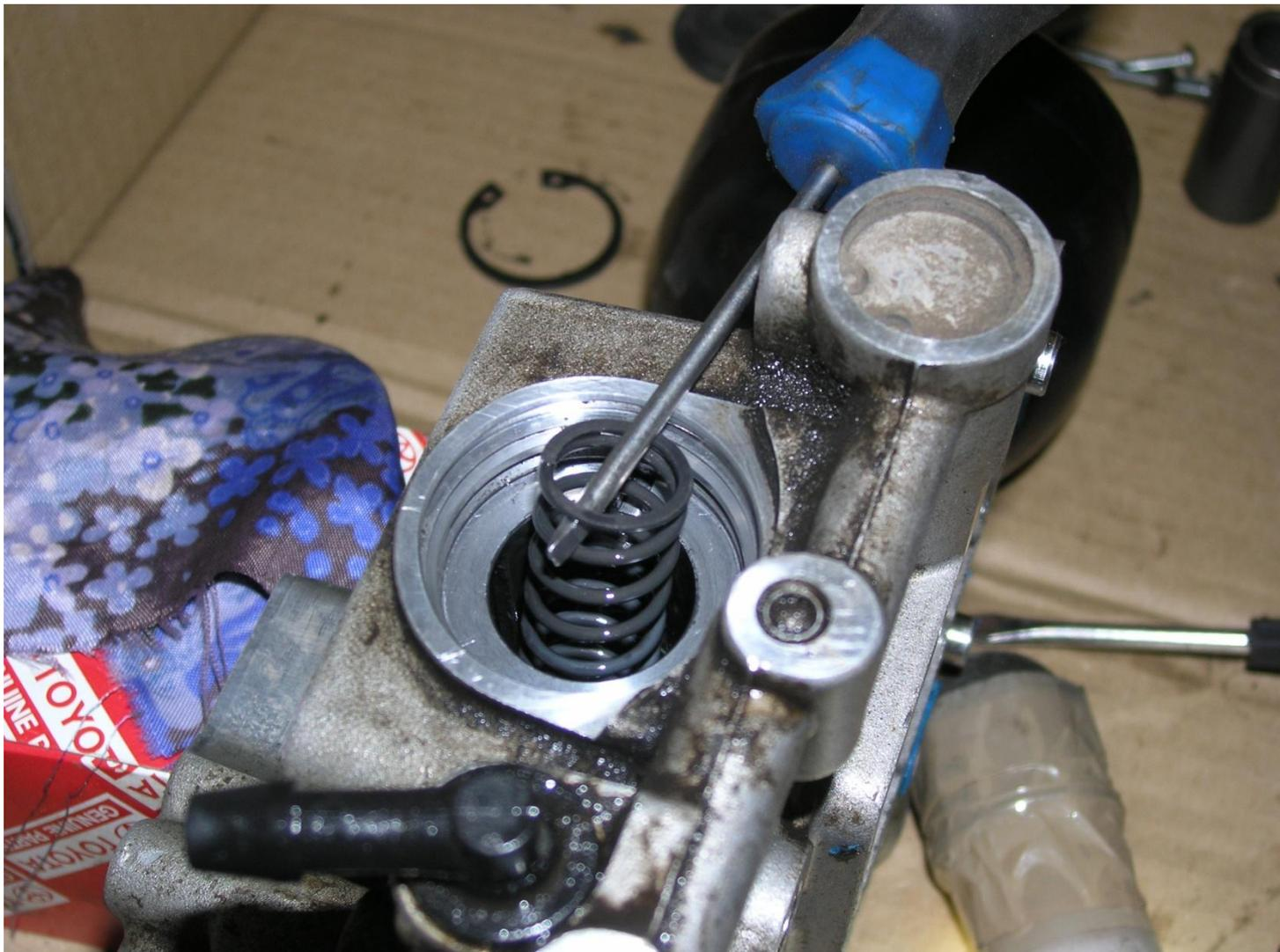
5. Извлекаем пружину поршня
