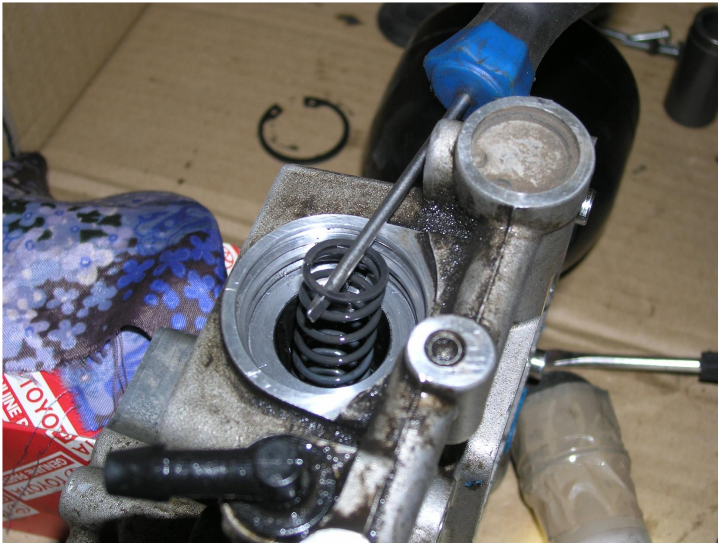
5. Извлекаем пружину поршня
