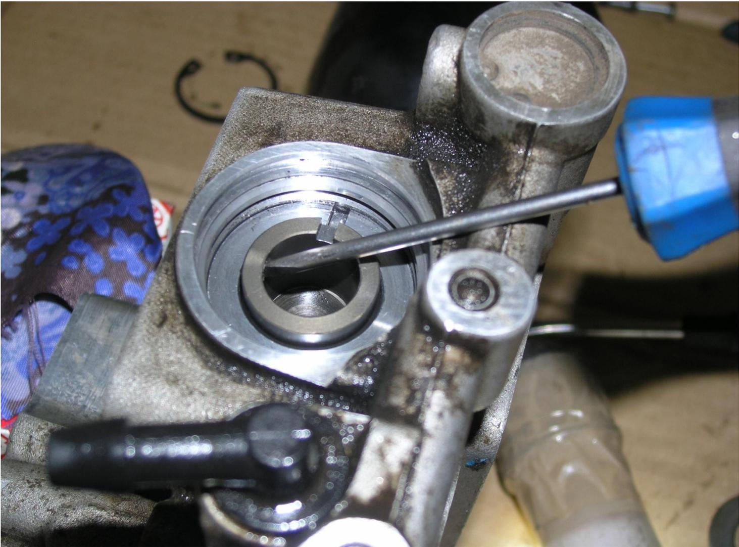
4. Извлекаем поршень рабочего цилиндра сцепления
