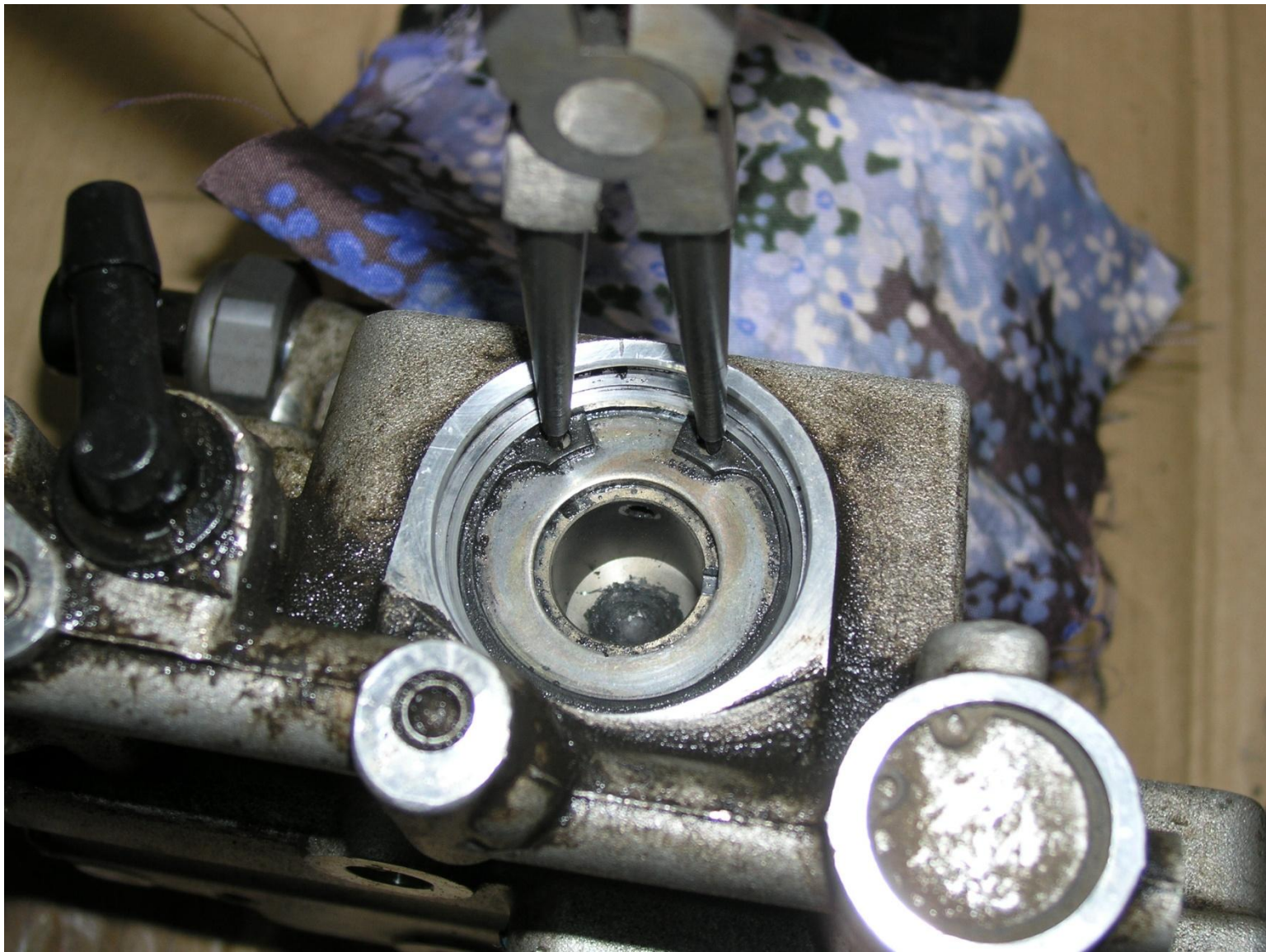
3. Удаляем стопорное кольцо
