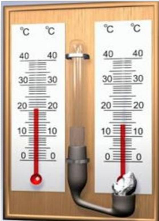
Психрометр Августа имеет два термометра: сухой и влажный. Они так называются потому, что конец одного из термометров находится в воздухе, а конец второго обвязан кусочком марли, погруженным в воду. Испарение воды с поверхности влажного термометра приводит к понижению его температуры. Сухой термометр показывает обычную температуру воздуха. Значения температур можно перевести в значение относительной влажности воздуха по специальной таблице.
