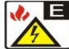
Эл.оборудование до 1000 В
