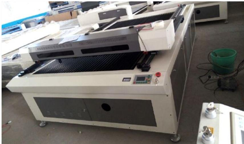
Размер рабочей поверхности 1300\*2500 мм, лазерная трубка RECI мощностью 90W, панель управления, направляющие, LED подсветка, шаговый двигатель, компрессор, USB порт, электронный ключ, программное обеспечение, вытяжка 550W 220V, настраиваемая головка, ЧИЛЛЕР CW-5000, гарантия на станок 1 год, гарантия на лазерную трубку 10 месяцев.
