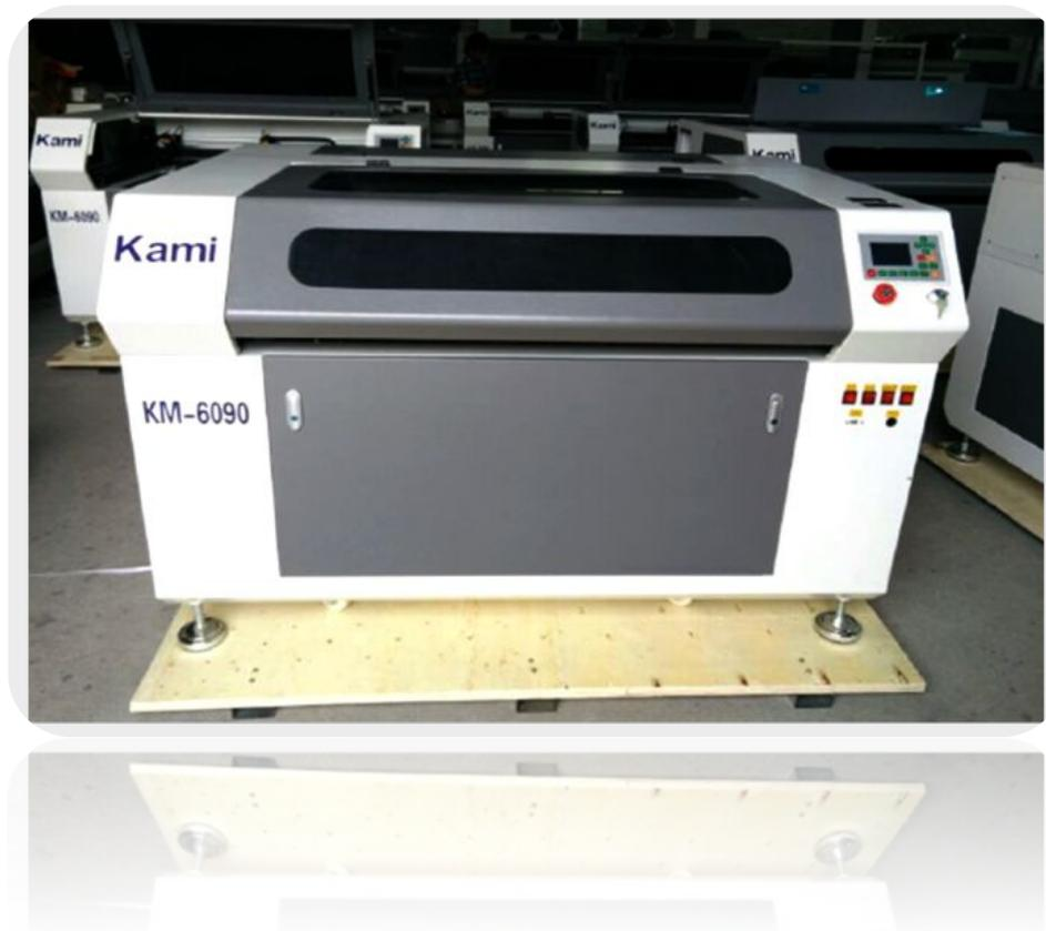
Размер рабочей поверхности 600\*900 мм, лазерная трубка RECI мощностью 90W, панель управления, направляющие, LED подсветка, шаговый двигатель, компрессор, USB порт, электронный ключ, программное обеспечение, вытяжка 550W 220V, настраиваемая головка, ЧИЛЛЕР CW-3000, гарантия на станок 1 год, гарантия на лазерную трубку 10 месяцев.
