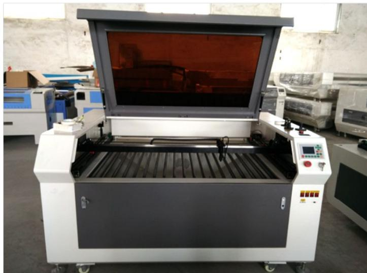
Размер рабочей поверхности 1300\*900 мм, лазерная трубка RECI мощностью 90W, панель управления, направляющие, LED подсветка, шаговый двигатель, компрессор, USB порт, электронный ключ, программное обеспечение, вытяжка 550W 220V, настраиваемая головка, ЧИЛЛЕР CW-3000, гарантия на станок 1 год, гарантия на лазерную трубку 10 месяцев.
