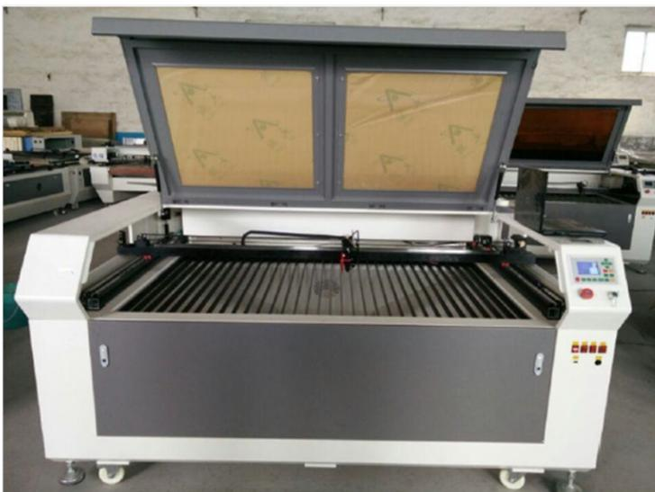
Размер рабочей поверхности 1600\*1000 мм, лазерная трубка RECI мощностью 90W, панель управления, направляющие, LED подсветка, шаговый двигатель, компрессор, USB порт, электронный ключ, программное обеспечение, вытяжка 550W 220V, настраиваемая головка, ЧИЛЛЕР CW-3000, гарантия на станок 1 год, гарантия на лазерную трубку 10 месяцев.
