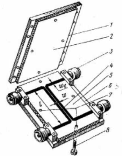
Рис. 23.18. Направленный ответвитель с боковой связью:
