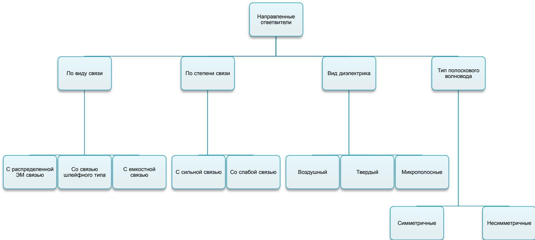
Полосковые направленные ответвители с распределенной ЭМ связью представляют собой параллельно расположенные и электромагнитно связанные полосковые волноводы с волной типа ТЕМ.
