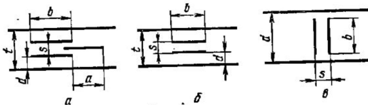
Рис. 5.4. Поперечное сечение полосковых ответвителей с сильной СВЯЗЬЮ.
