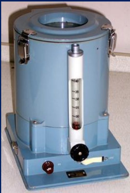
Аппарат Кротова для взятия проб воздуха
