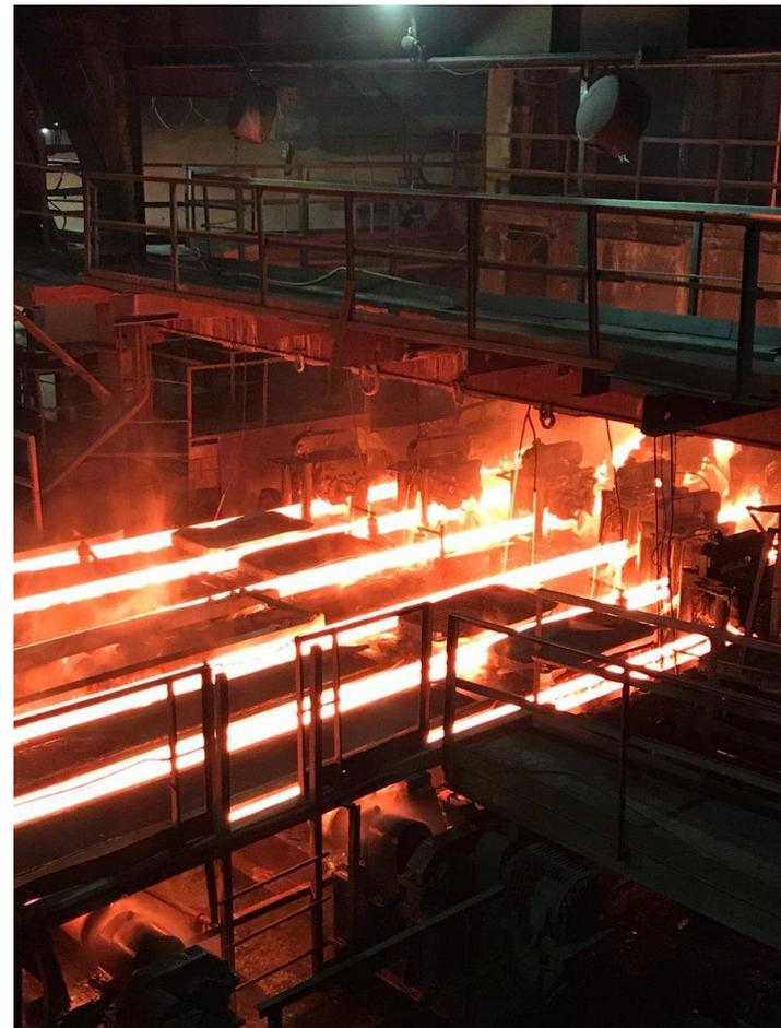
Нормализация проводится с целью получения мелкозернистой феррита - перлитной микроструктуры. Таким образом, крупнозернистые и неравномерные микроструктуры, например, литые, сварные, и подвергнутые наклепу стали можно превратить в стали с новой, однородной и тонкой структурой. После термообработки материал медленно охлаждают на воздухе.
