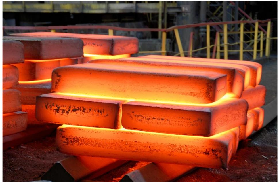
Этот вид обработки применяется главным образом для легированных сплавов. Изометрический отжиг стали заключается в нагревании металла до аустенитного состояния с последующим ускоренным охлаждением до 660-680° С. Затем заготовку выдерживают при этой температуре, пока аустенит не превратится в перлит. После этого металл охлаждают на воздухе естественным способом.
