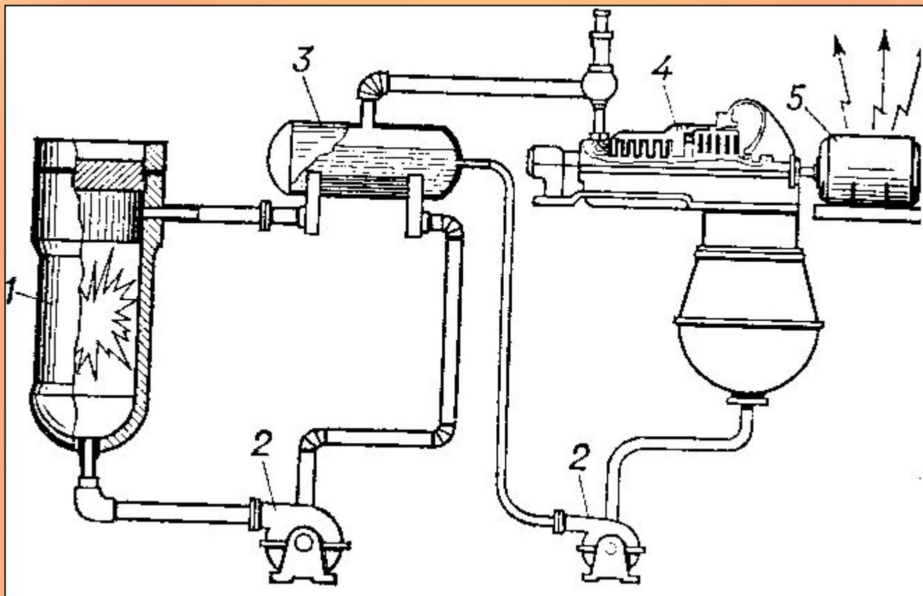
Принцип работы АЭС: 1-ядерный реактор, 2-циркуляционный насос, 3-теплообменник, 4-турбина, 5-генератор электрического тока.
