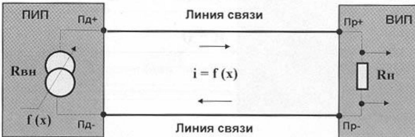
а) схема подключения датчика с токовым выходом
