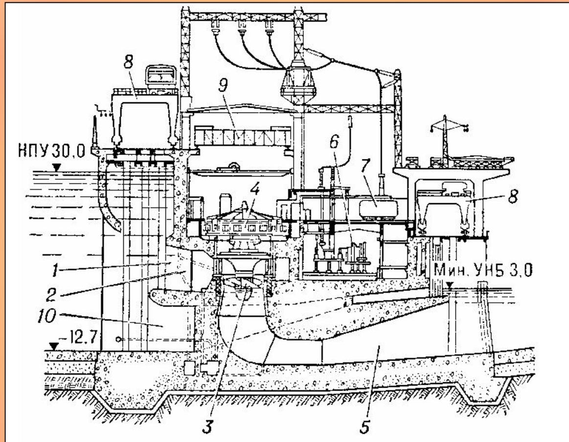
Разрез здания Волжской ГЭС : 1 - водоприемник; 2 - камера турбины; 3 - гидротурбина; 4 - гидрогенератор; 5 - отсасывающая труба; 6 - распределительные устройства (электрические); 7 - трансформатор; 8 - порталные краны; 9 - кран машинного зала; 10 - донный водосброс; НПУ – нормальный подпорный уровень, м; УНБ – уровень нижнего бьефа, м.
