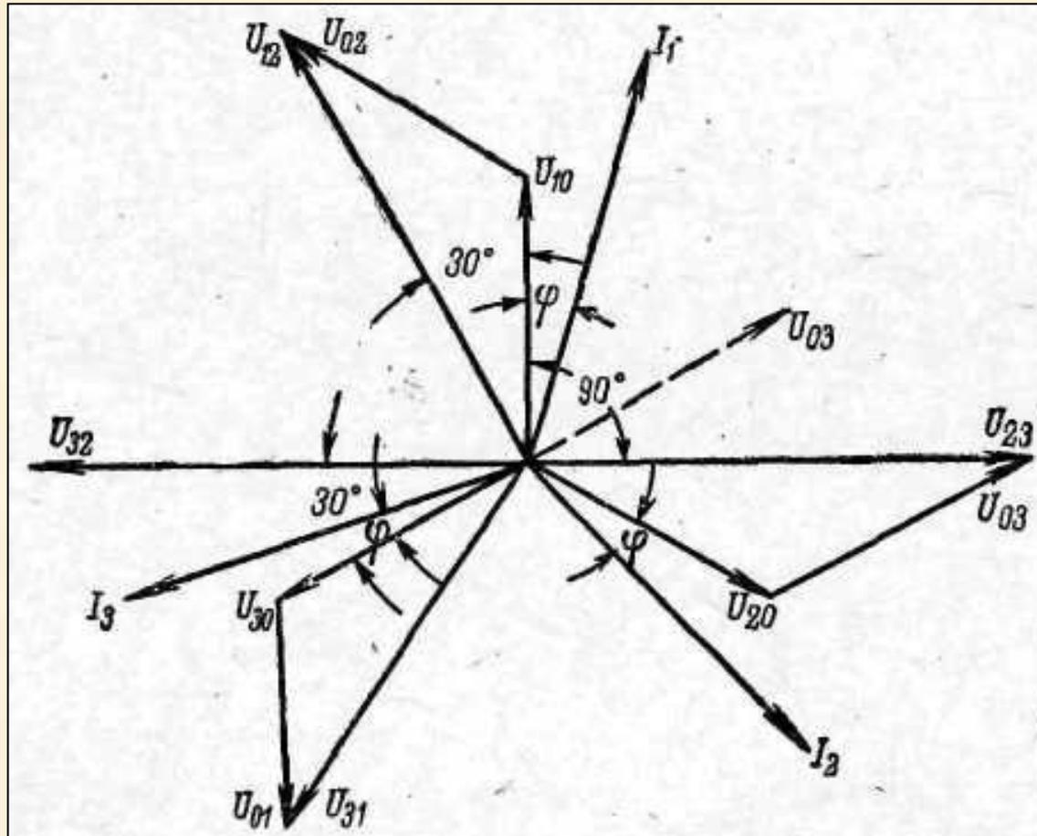
Рис. 4.14. Диаграмма токов и напряжения нагрузки звездой
