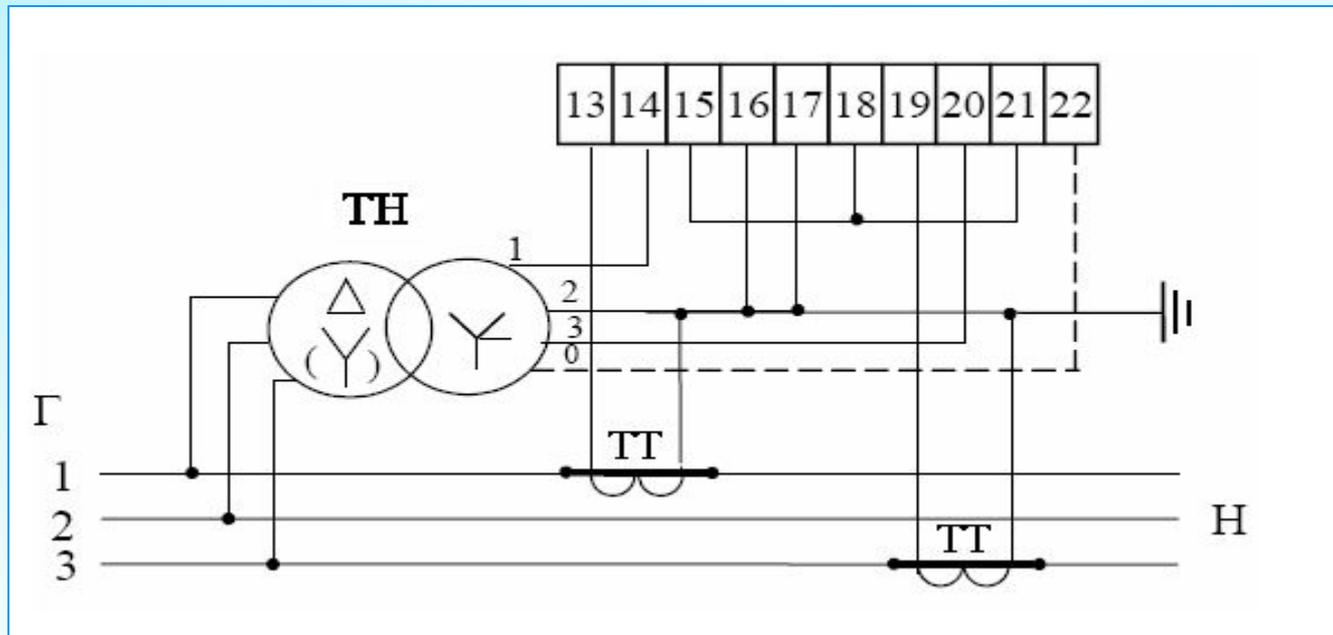
В трехпроводных сетях "нулевой" провод к зажиму 22 допускается не подключать
