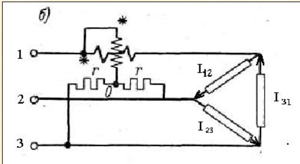
Рис. 4.11. Измерение мощности в трехфазной трехпроводной цепи
