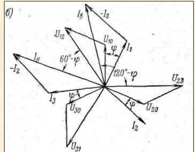
Рис. 4.20. Включение двухэлементного счетчика реактивной энергии с дополнительными последовательными обмотками
