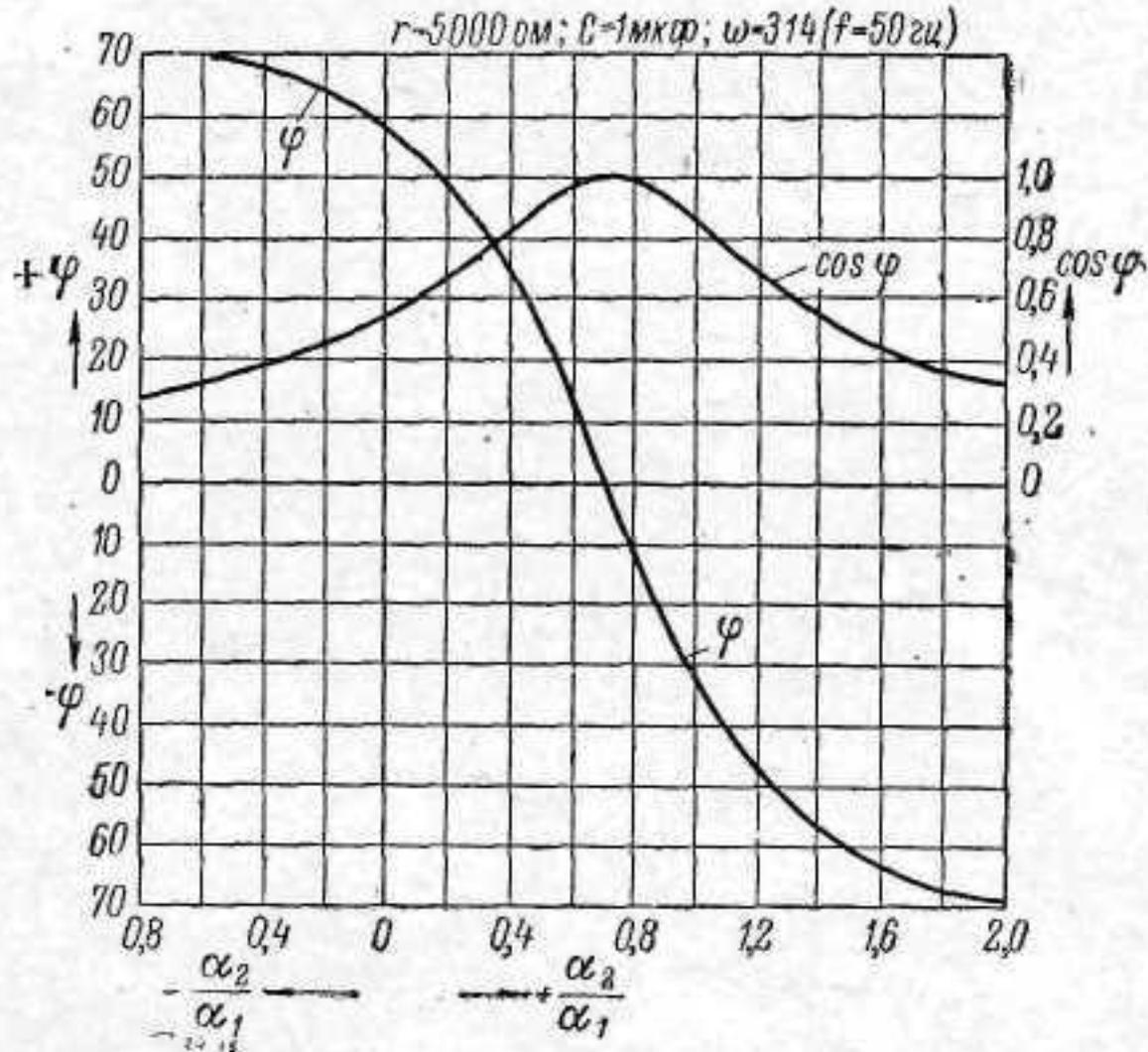
Рис. 4.22. Кривая зависимости коэффициента мощности от отношения показаний ваттметра в цепи рис. 4.21
