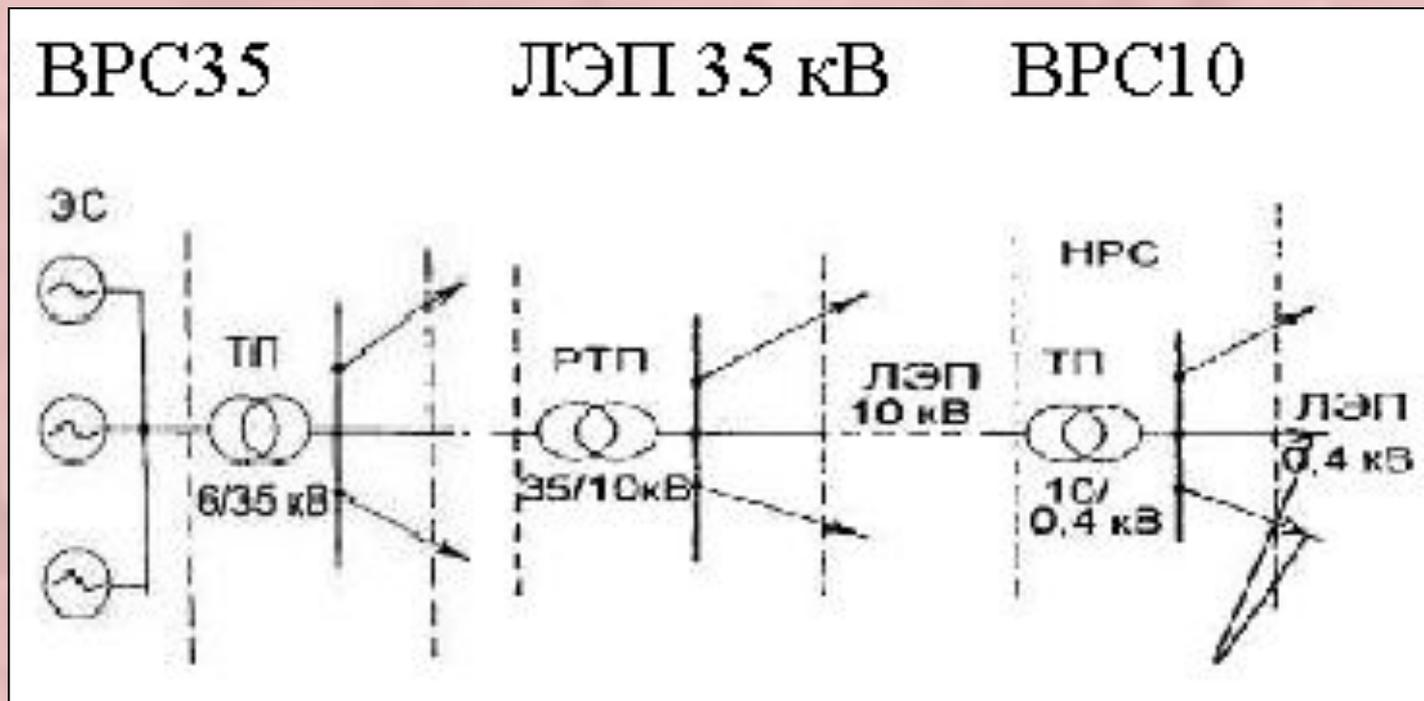
ЭС — электростанция; ТП — потребительская трансформаторная подстанция 10/0,4 кВ; РТП — районная трансформаторная подстанция 35/10 кВ; ВРС35, ВРС10 — вспомогательная распределительная сеть напряжением 35 и 10 кВ; НРС — низковольтная потребительская распределительная сеть напряжением 0,4/0,23 кВ; ЛЭП — линия электропередачи 35, 10, 0,4 кВ.
