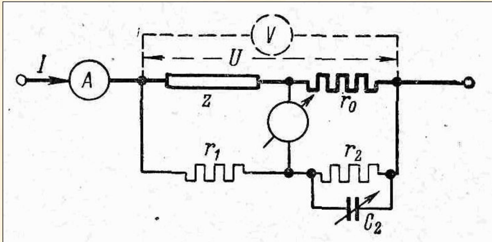
Рис. 4.9. Мостовая цепь измерения мощности
