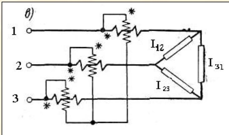
Рис. 4.12. Измерение мощности в трехфазной трехпроводной цепи
