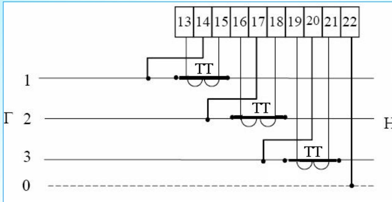
В трехпроводных сетях "нулевой" провод к зажиму 22 допускается не подключать
