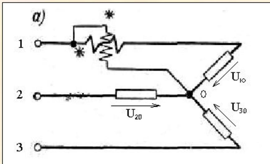
Если нагрузка трехфазной трехпроводной системы симметрична и нейтральная точка доступна, то измерение мощности и энергии может быть осуществлено одним ваттметром и одним счетчиком
