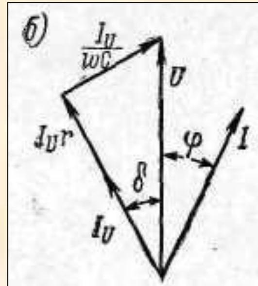
Рис. 4.21. Измерение коэффициента мощности однофазной цепи ваттметром
