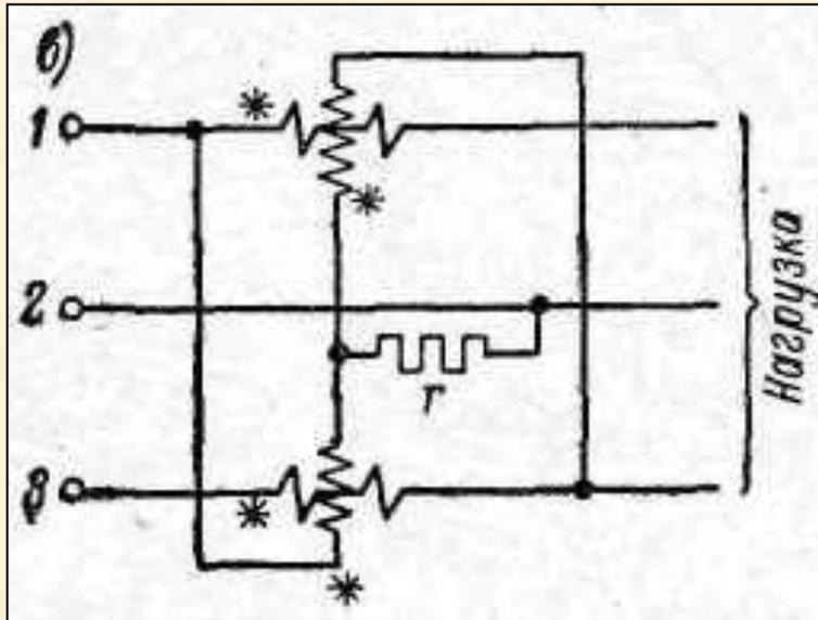
Для простой асимметрии предназначена также схема двух ваттметров с искусственной нейтральной точкой. Сопротивление  $r$  в этой схеме должно быть равно сопротивлению параллельной цепи каждого ваттметра. Показания ваттметров в этой схеме будут:
