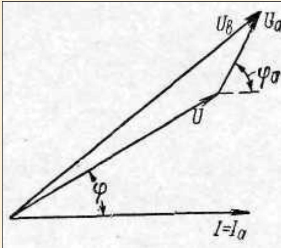
Рис.4.8. Диаграмма для измерения мощности ваттметра, рис. 4.4.(а) на переменном токе
