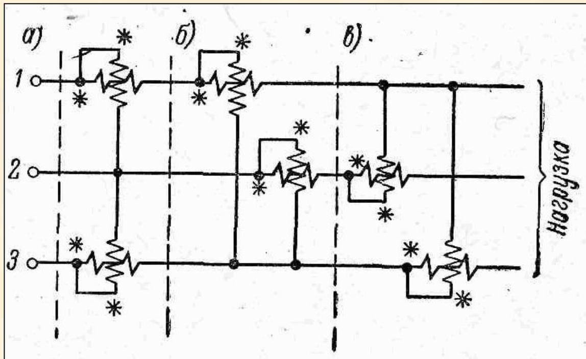
сумма показаний двух ваттметров, включенных по одной из трех схем рис. 8, всегда равна полной мощности приемника независимо ни от способа его включения, ни от степени симметрии напряжений и токов системы.
