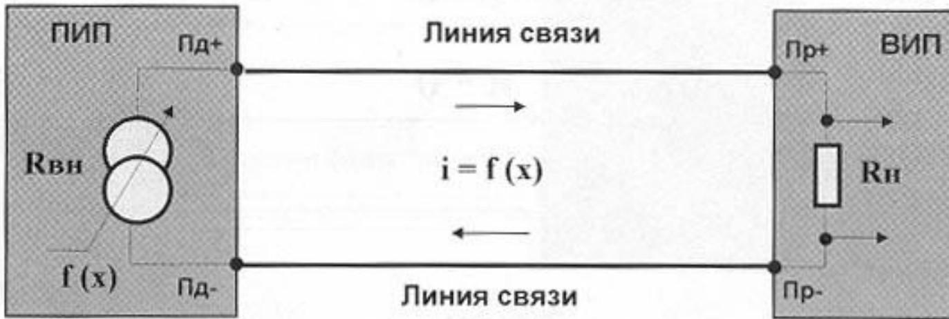
а) схема подключения датчика с токовым выходом
