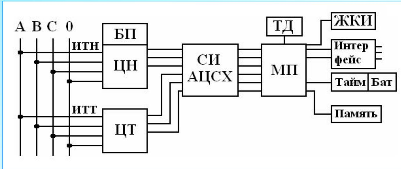
ИТН – измерительный трансформатор напряжения (при включении в линию 10 кВ).
