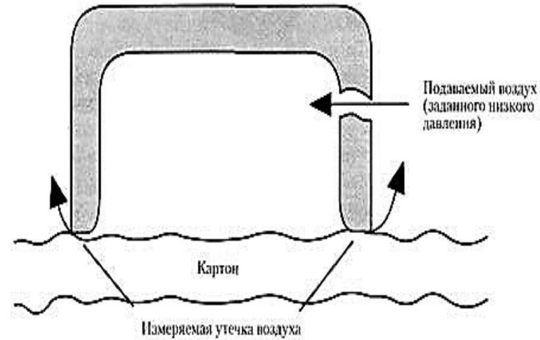
Наиболее распространенные методы определения **шероховатости и гладкости** основаны на применении приборов *Parker PrintSurf (PPS)* фирмы *Bendtsen and Sheffield*.
