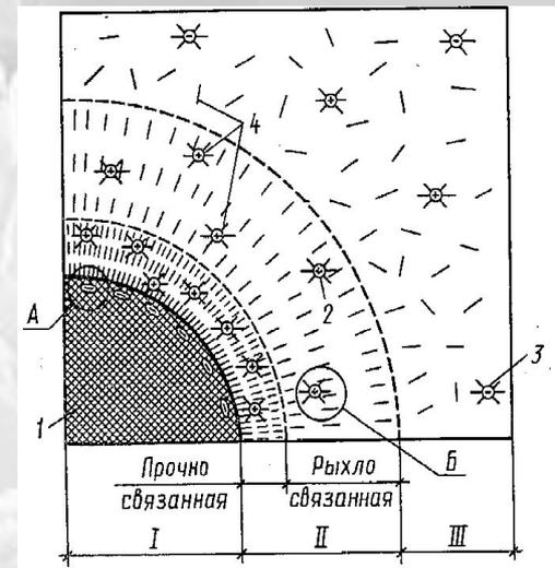
I – твердая частица; II – связанная вода; III – свободная вода
