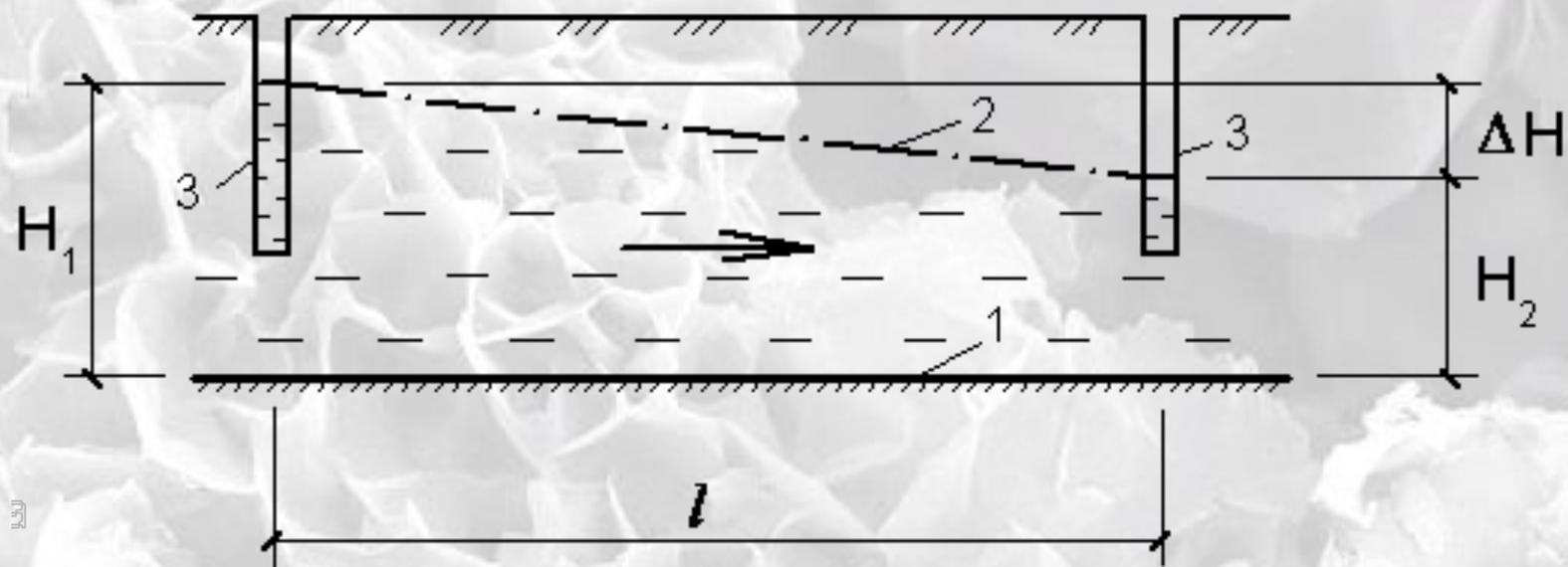
1 – кровля водоупора, 2 – уровень грунтовых вод (УГВ),
