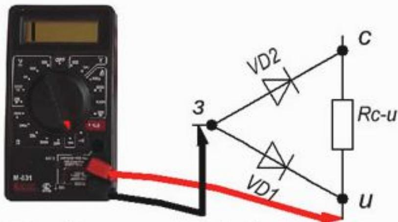
Так же проверяем исправность p-n перехода сток-затвор. То есть включаем мультиметр в режим проверки диодов. Красный (плюсовой) щуп мультиметра подключаем на затвор (имеет p-проводимость), а черный на сток. Мультиметр должен показать падение напряжения на открытом p-n переходе затвор-сток, которое должно быть в пределах 600-700 мВ.
