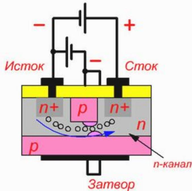
Таким образом, изменяя напряжение между затвором и истоком, мы можем управлять током через канал полевого транзистора.
