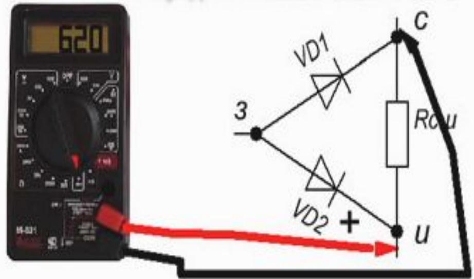
Значения сопротивления канала при разной полярности подключения щупов должны быть примерно одинаковыми.
