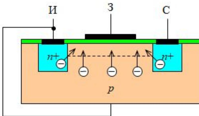
Канал возникает только при подаче на затвор напряжения. В примере напряжение, подаваемое на канал, должно быть *положительным*. Если канал *p*-типа, то напряжение на затвор надо подавать *отрицательное*.
