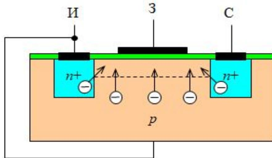
Когда напряжение затвора превысит некоторое отпирающее (пороговое) значение, то в приповерхностном слое концентрация электронов настолько увеличится, что превысит концентрацию дырок, и в этом слое произойдёт так называемая инверсия типа электропроводности, т.е. образуется тонкий канал  $n$ -типа и транзистор начинает проводить ток. Чем больше положительное напряжение затвора, тем больше проводимость канала и ток стока. Таким образом, транзистор работает только в режиме обогащения канала.
