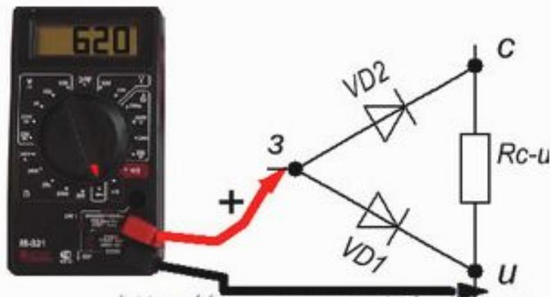
Меняем полярность подключения щупов (красный на исток, черный на затвор), мультиметр, в случае исправности транзистора показывает бесконечность (на дисплее «1»), то есть переход включен в обратном направлении и закрыт.
