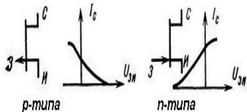
С изолированным затвором, встроенным каналом
