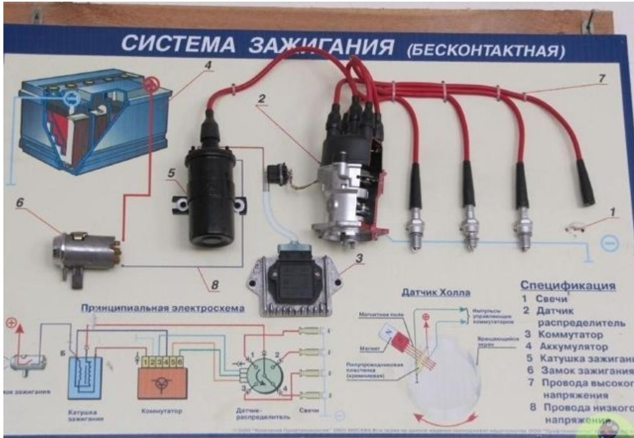
Электронная бесконтактная система зажигания включает в себя следующие узлы: источники электрического тока, катушку зажигания, датчик-распределитель, коммутатор, свечи зажигания, провода высокого и низкого напряжения, выключатель зажигания.
