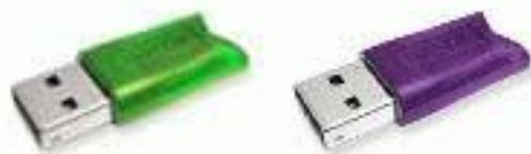
**синий и зеленый** — ключи для серверных приложения, 32-битный — синий, 64-битный — зеленый. Синий можно отличить от однопользовательского маркировкой. Маркировка — **H4 M1 ENSR8** и **Max EN8SA**.
