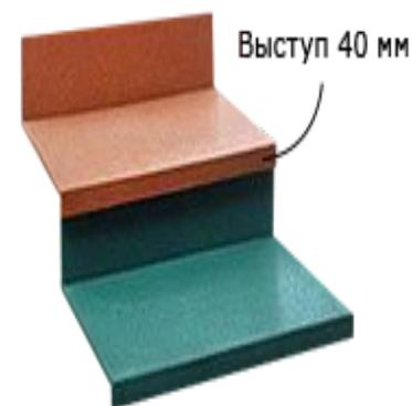
Задняя часть ступени при монтаже обрезается по размеру ступени лестничного марша, из обрезка выполняется подступенник.
