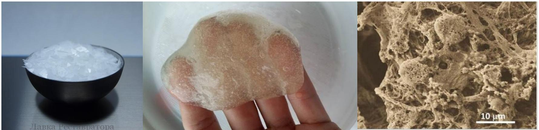
Для придания гидрогелю вязкости, необходимой для печати на 3D-принтере, в его составе будет использована "наноглина" — минеральное вещество, которое часто используют как добавку к полимерным композитам. При сжатии фигурки из данного гидрогеля почти в 100 раз материал восстанавливает свою структуру, также он не рвётся при пятикратном растяжении.
