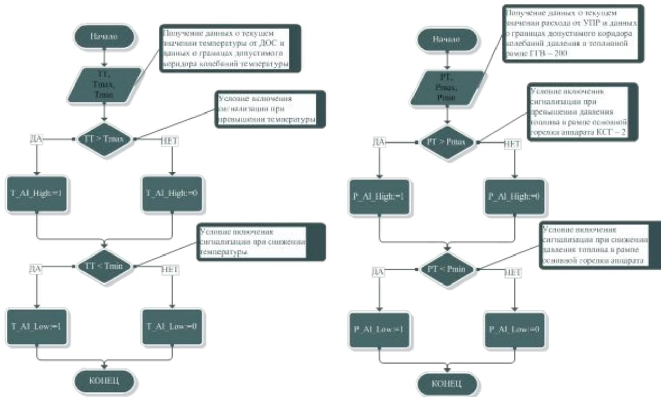
Алгоритмы программ предупредительной сигнализации по давлению газа в топливной рампе основной горелки аппарата КСГ – 2 и температуры водонефтяной эмульсии на выходе единого комплекса НБАП ПБА – 2
