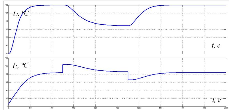
Графики ПП регулирования температуры водонефтяной эмульсии на выходе аппаратов модуля теплогенерации и теплообмена соответственно, синтезированной системы регулирования температуры водонефтяной эмульсии на выходе печи ПБА – 2
