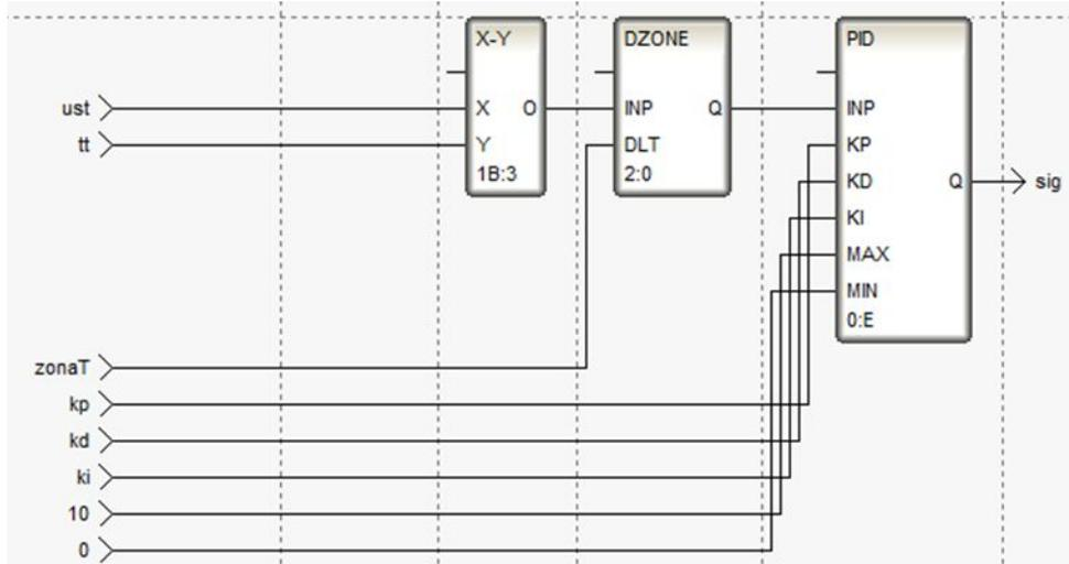
**Листинг программы предупредительной сигнализации по температуре водонефтяной эмульсии на выходе блочной нагревательной печи ПБА – 2**
