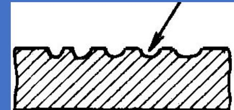
2.4. **Грубая поверхность** – такая поверхность, когда ее шероховатость превышает допустимые нормы. Чаще всего образуется при формовке по-сырому с использованием крупнозернистого формовочного песка. Применение песков средних фракций, а также противопригарных покрытий формовка по-сухому являются надежным средством получения отливок без этого дефекта.
