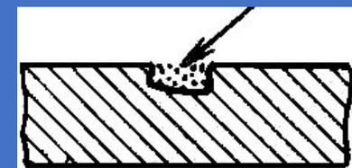
2.10. **Залив** – тонкие металлические приливы, возникшие при проникании металла в зазоры по разъему формы и знакам стержней.
