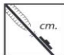
Двоколійна залізниця. Станція. Виймка
