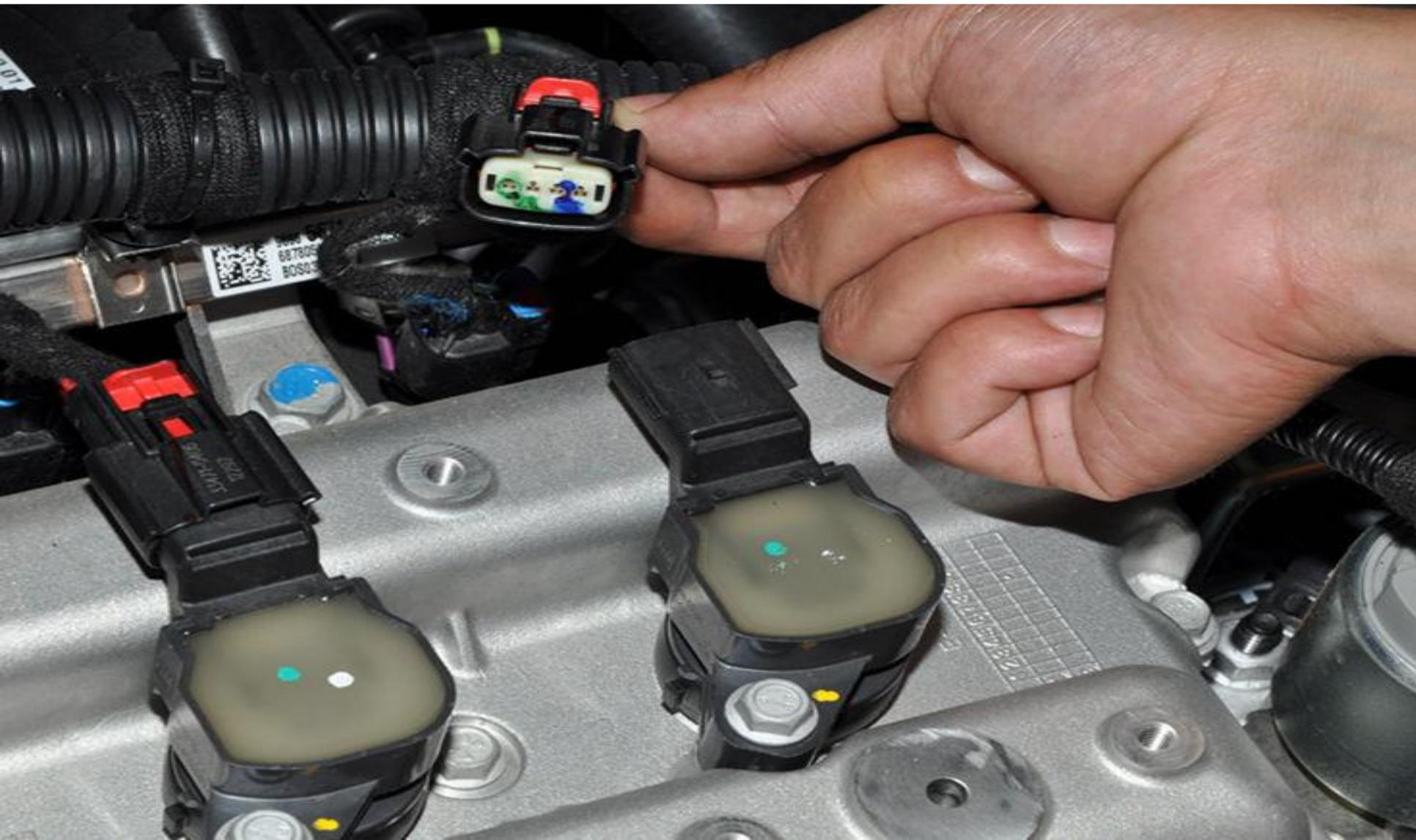
Куда мы устанавливаем катушку зажигания и откуда подается на нее напряжение?
