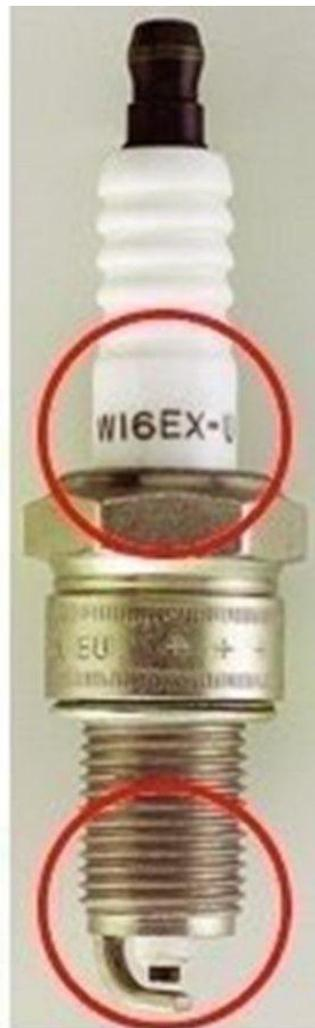
Поддельная свеча зажигания
