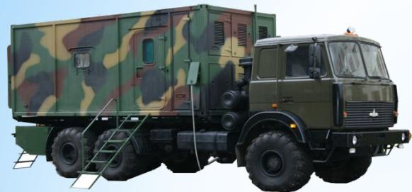
ИЦ-2006/1 предназначен для анализа, разработки и распространения информации в сети Интернет, приема-передачи информации в локальных сетях и по спутниковым каналам связи
