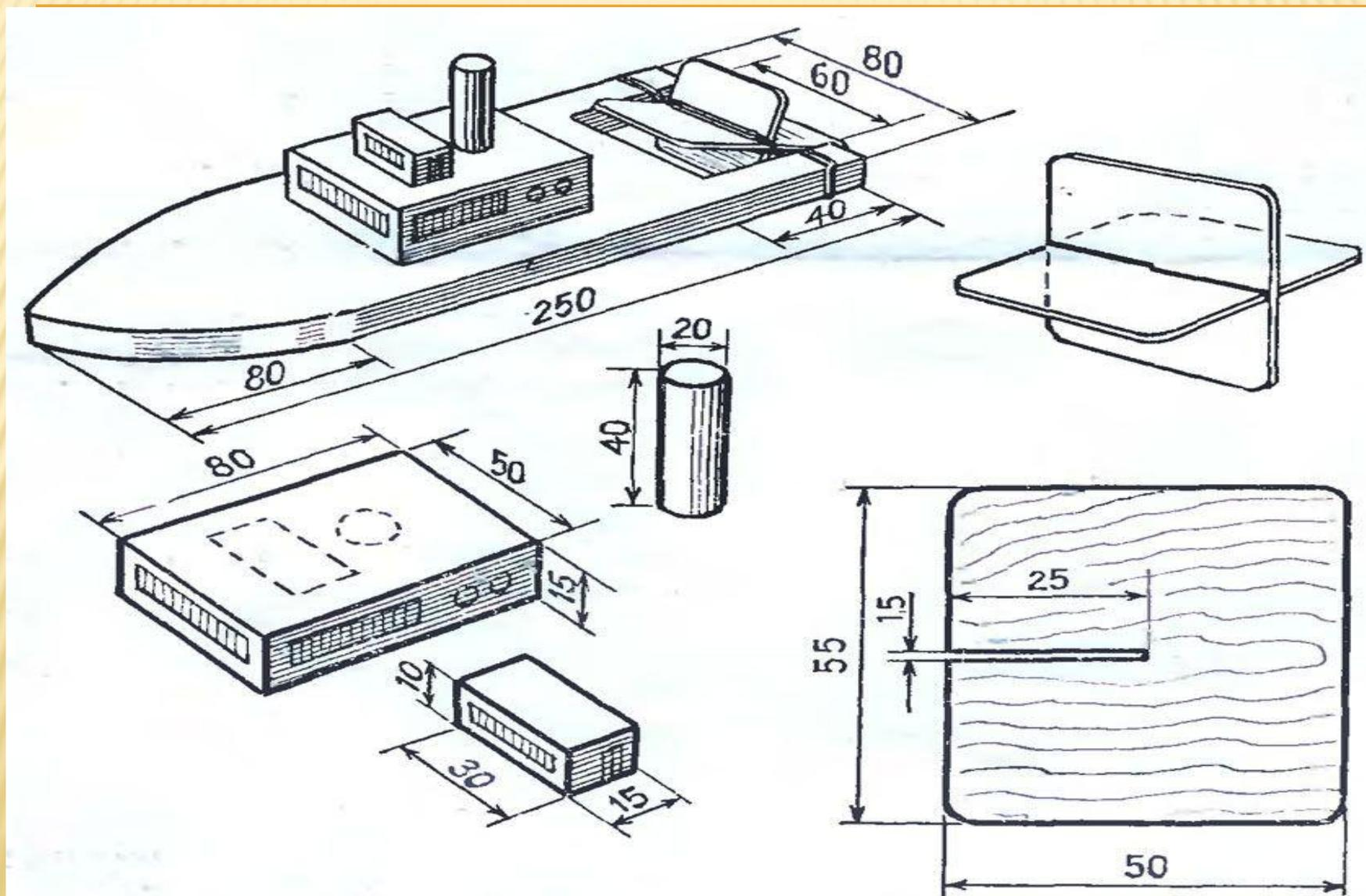
Корпус самоходной лодочки выпиливают из толстой (например пятислойной) фанеры или из дощечки толщиной в 5-8 миллиметров — по размерам, указанным на схеме. Для водяного колеса из фанеры вырезают два квадрата, в них делают прорезы по толщине фанеры, углы можно слегка закруглить.
